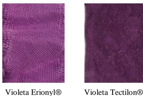
Figura 5. Tintura de seda con colorantes Erionyl® y Tectilon® al 3%
