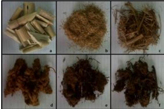
Fig. 1. Efecto del pretratamiento *steam explosion* a diferentes severidades. a) *Gynerium sagittatum*. b) Se 3,15. c) Se 3,4. d) Se 4. e) Se 4,6. f) Se 4,8.
