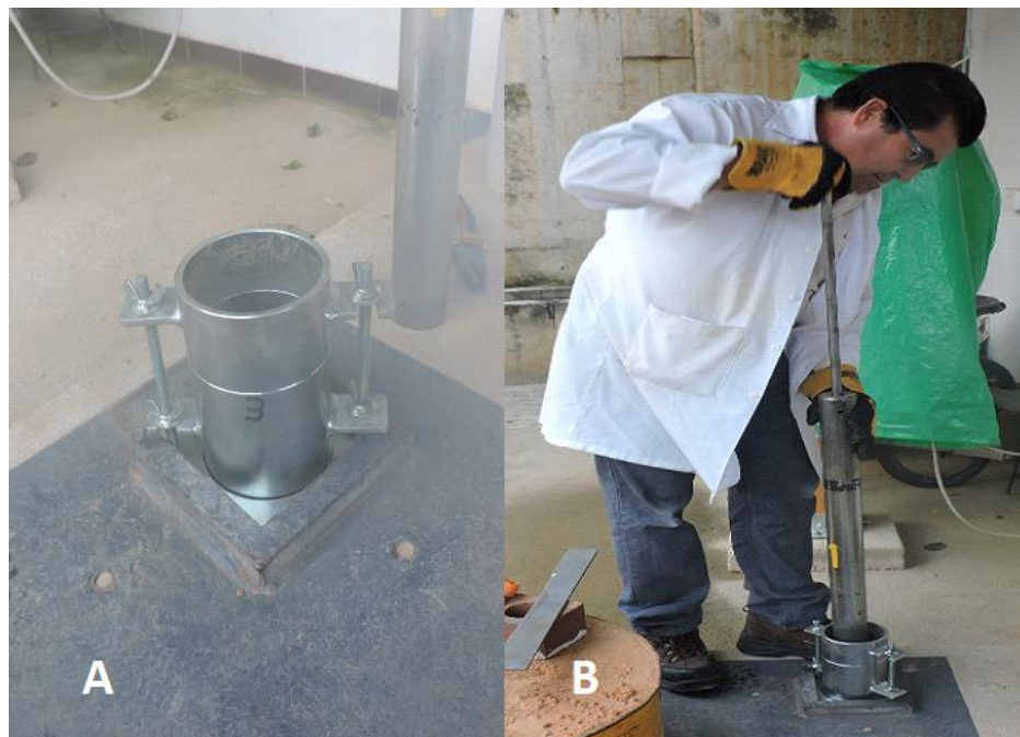
Figura 5. Molde empleado (A) y proceso de compactación con el martillo (B).
