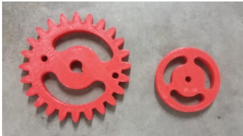
Figura 37. Engranajes elaborados con impresión 3D.
