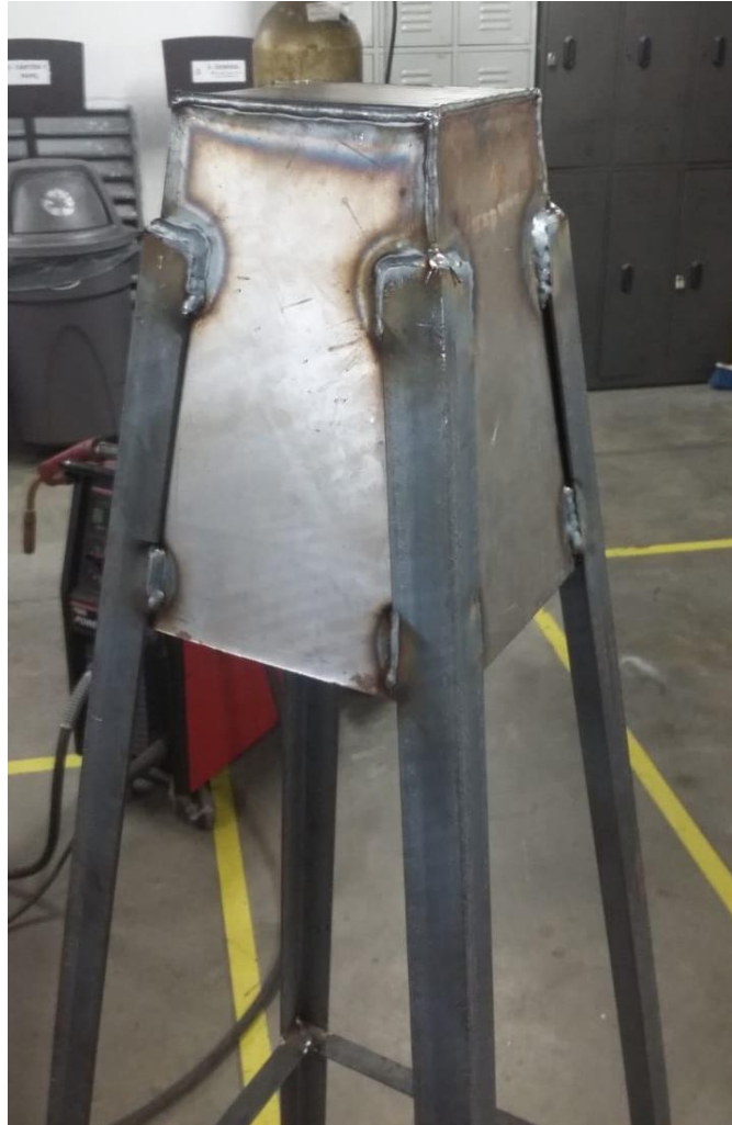
Figura 33. Torre de la turbina.
