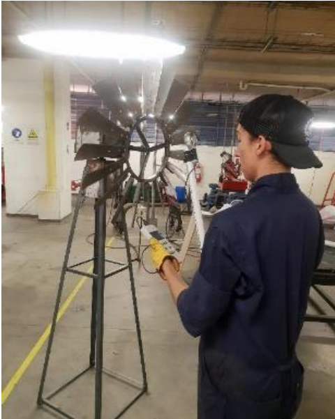
Figura 56. Pruebas realizadas a la turbina con un ventilador industrial.
