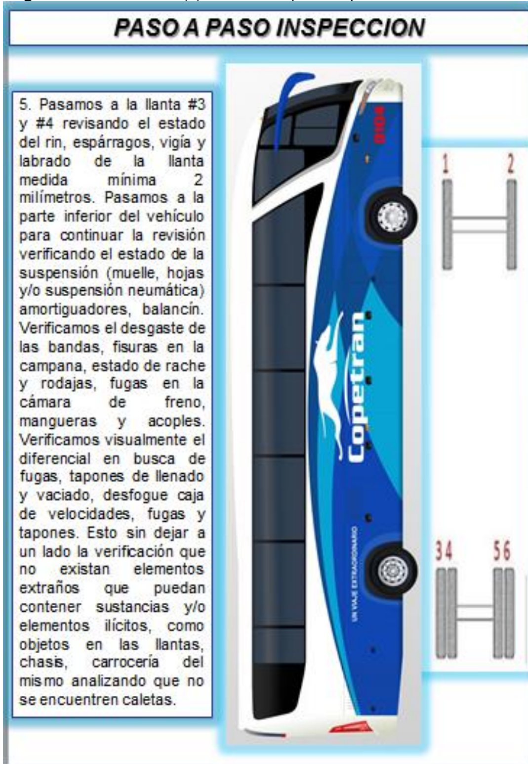
Figura 15. Paso a Paso (5). Guía de inspección para un Bus Preferencial.
