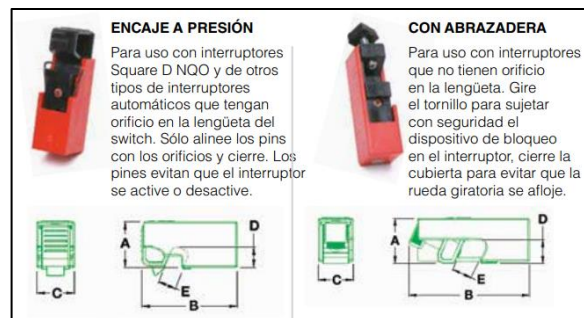
Figura 8. Dispositivo de bloqueo para interruptores.
