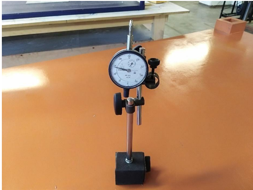
Figura 33. Comparador de caratula utilizado para medir el desplazamiento vertical de la probeta.
