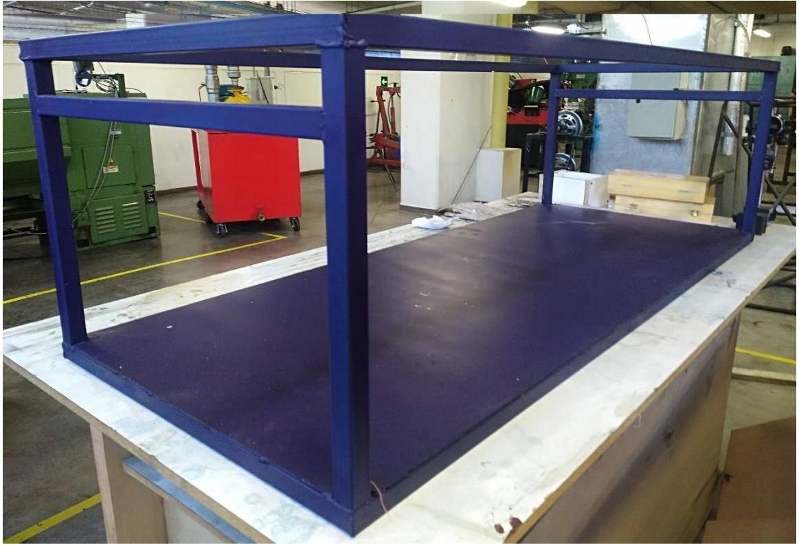
Figura 30. Resultado final del proceso de protección y pintura de la estructura.
