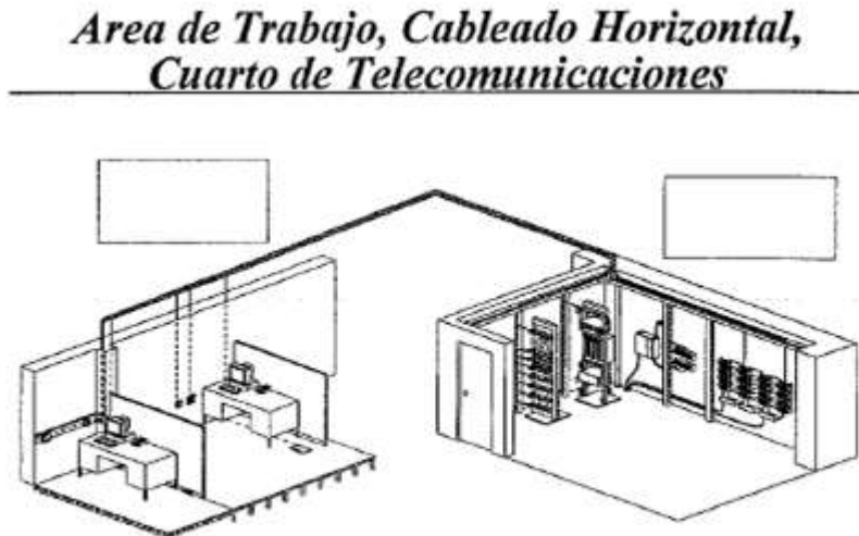
FIGURA 16. AREA DE TRABAJO Y CUARTO DE TELECOMUNICACIONES.
