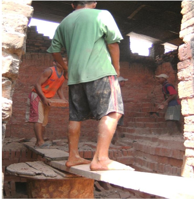
Fotografía 14. Extracción Manual del Ladrillo Quemado en el Horno
