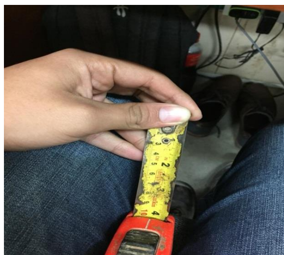
Figura 6. Flexómetro oxidado en mal estado.
