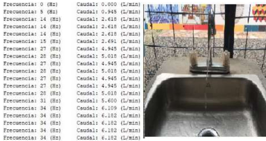
Figura 49. Flujo de agua lavaplatos y monitoreo Caudalímetro n°2 salida agua lluvia.
