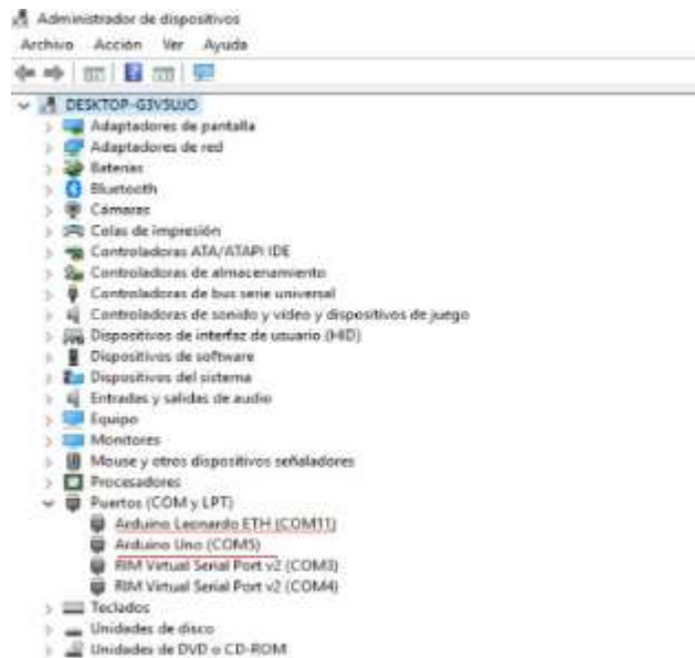
Figura 77. Verificación puerto COM y LPT
