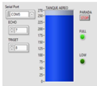
Figura 53. Calibración ultrasonido tanque aéreo nivel máximo.
