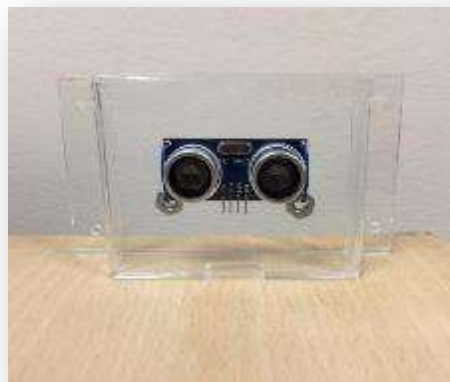
Figura 38. Ultrasonido con base en acrílico para la instalación.
