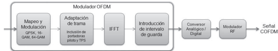
Fig. 5 Esquema simplificado proceso de obtención de señal COFDM.
