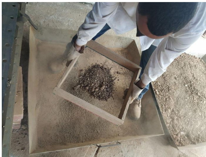
Figura 13. Cernido del material por el tamiz No. 4
