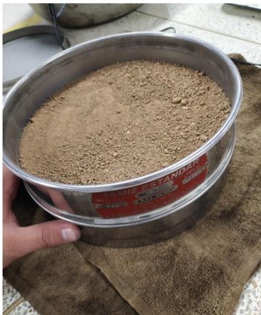
Figura 7. Cernido del material por tamiz No 40.
