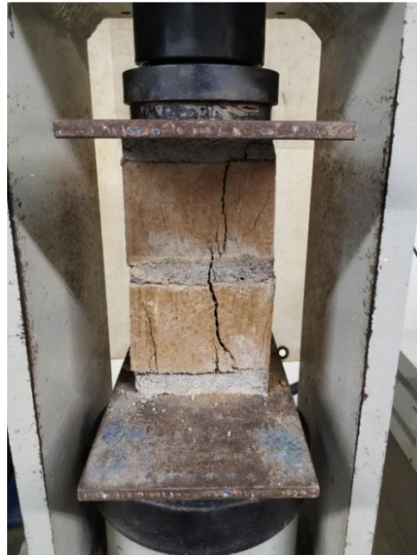
Figura 31. Prueba de Compresión del Bloque suelo-cemento
