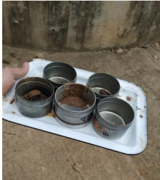
Figura 11. Cápsulas las muestras secas del límite líquido y plástico
