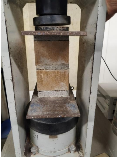
Figura 26. Prueba de compresión a espécimen
