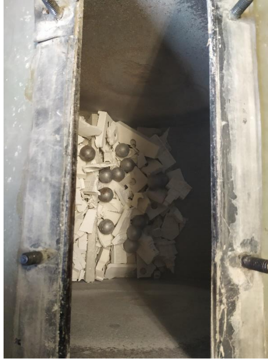
Figura 18. Material dentro de la máquina de los ángeles.
