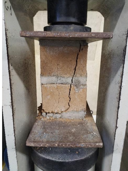
Figura 32. Prueba de Compresión del Bloque suelo-cerámica
