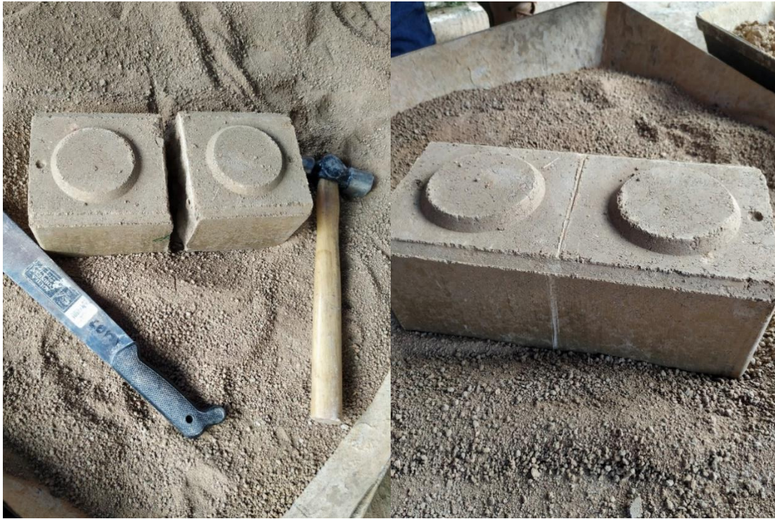
Figura 22. Corte de los bloques según la NTC 5324.
