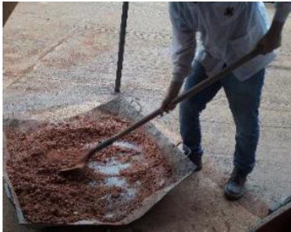
Fotografía 15. Mezcla del suelo arcilloso con la humedad óptima.
