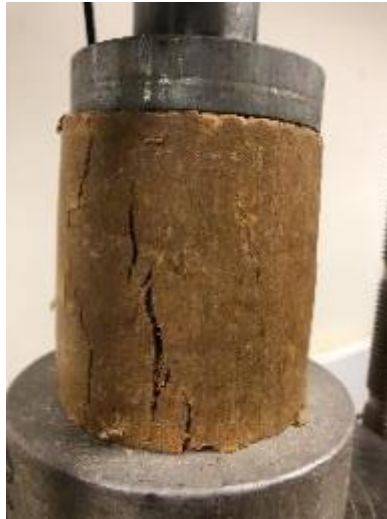
Fotografía 6. Ángulo de falla de la muestra.
