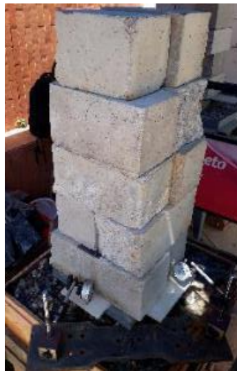
Fotografía 24. Carga del modelo a escala con los deformímetros.
