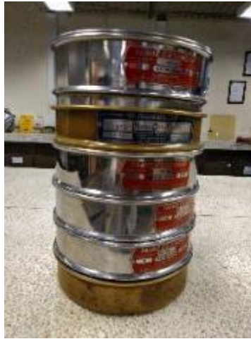
Fotografía 1. Equipo para el ensayo de granulometría
