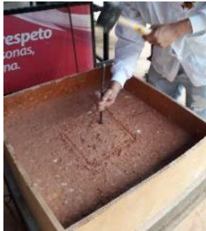
Fotografía 19. Determinación de la profundidad y diámetro para los drenes.
