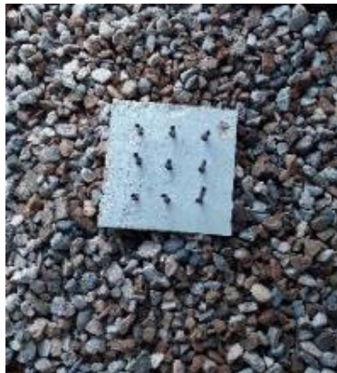
Fotografía 22. Estrato de grava para el estrato con la placa de concreto.
