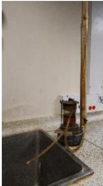
Fotografía 3. Equipo para ensayo de permeabilidad.
