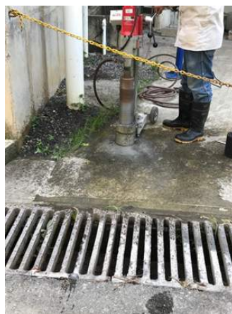
Figura 27 Corte de briquetas para módulos resilientes Fuente: propia
