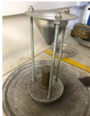
Figura 11 Ensayo de determinación de contenido de vacíos en agregados finos Fuente: propia
