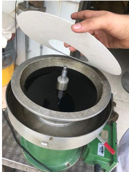
Figura 2 Ensayo para la extracción de asfalto Fuente: propia
