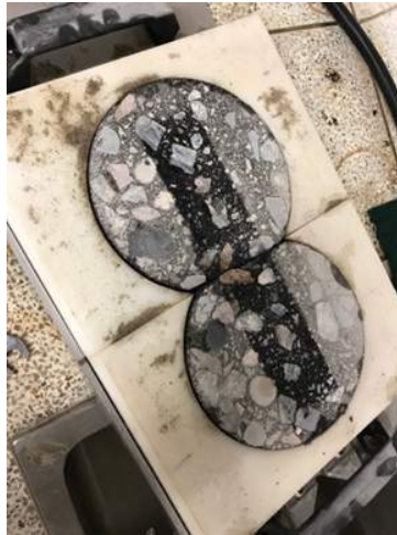
Figura 26 Ejecución del ensayo rueda de Hamburgo Fuente: propia
