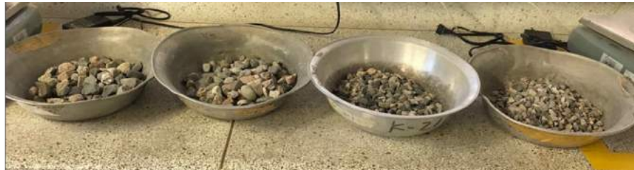
Figura 4 Muestra para ensayo Máquina de los ángeles Fuente: propia
