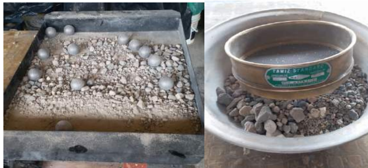
Figura 5 Ensayo máquina de los ángeles Fuente: propia
