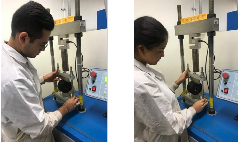
Figura 23 ejecución del ensayo de adherencia Fuente: propia
