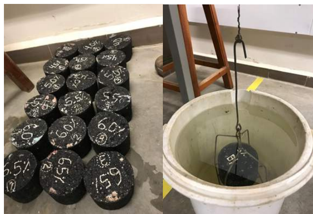
Figura 20 Briquetas desencofradas y toma de gravedad específica BULK Fuente: propia
