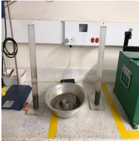
Figura 12 Ensayo equivalente de arena Fuente: propia
