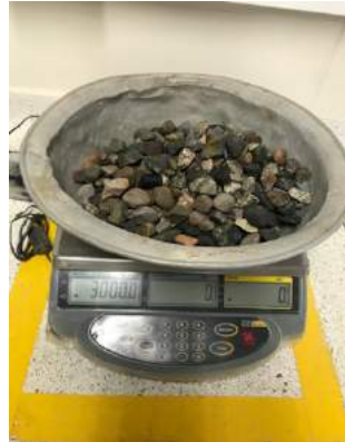
Figura 9 Ensayo densidad de agregados gruesos Fuente: propia
