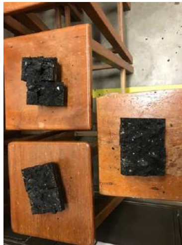
Figura 24 Briquetas falladas Fuente: propia
