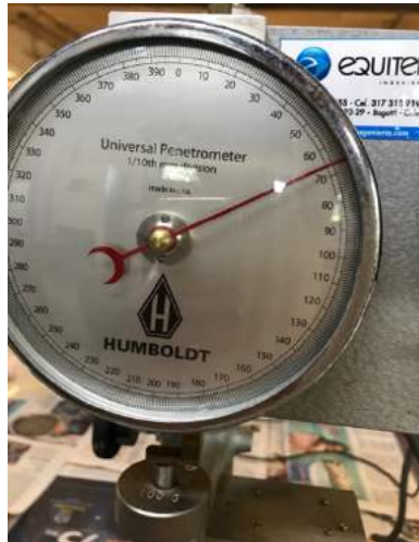
Figura 15 Ensayo de penetración del asfalto Fuente: propia
