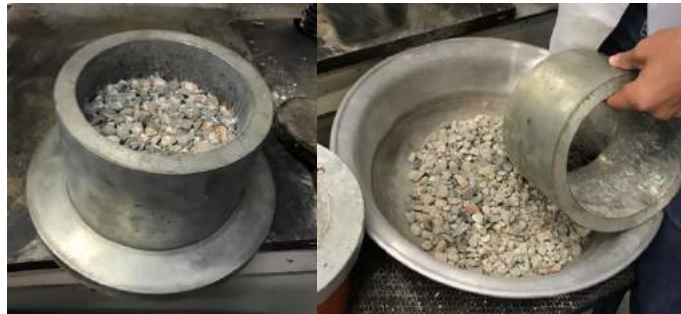
Figura 7 Ensayo 10% de finos Fuente: propia
