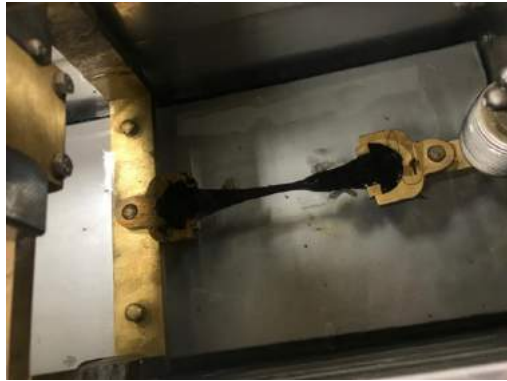
Figura 14 Ensayo ductilidad de materiales asfálticos Fuente: propia
