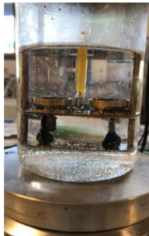
Figura 17 Ensayo punto de ablandamiento Fuente: propia
