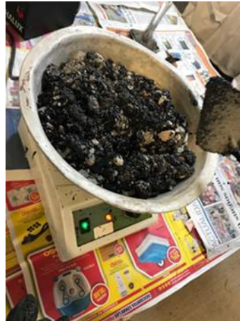
Figura 19 Mezcla de los agregados y asfalto Fuente: propia
