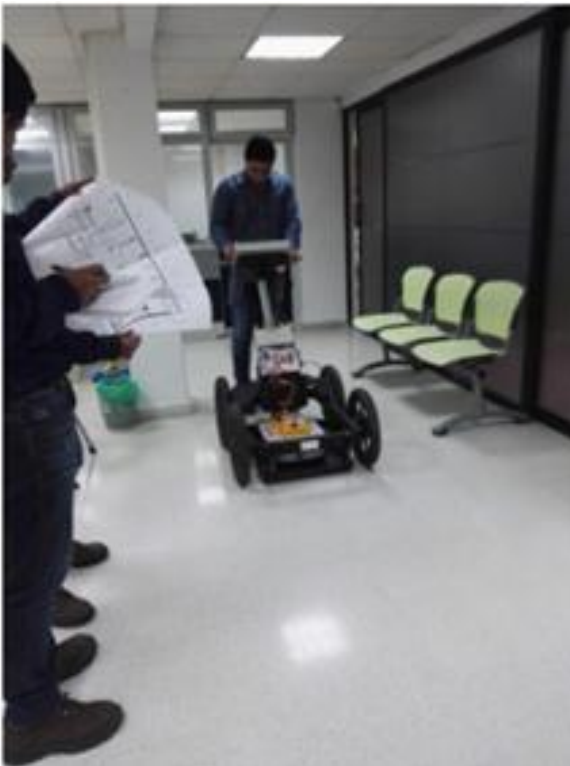
Ilustración 97 Estudio de suelos con el Georadar en la zona administrativa.
