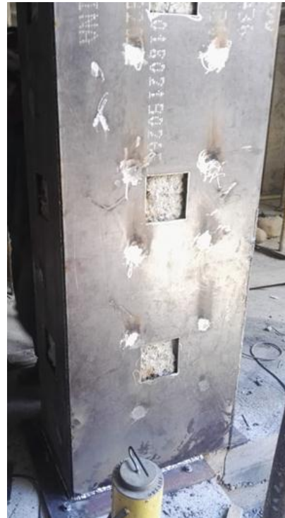
Ilustración 52 Acabado final de las perforaciones de la lámina en la Cara No 3.
