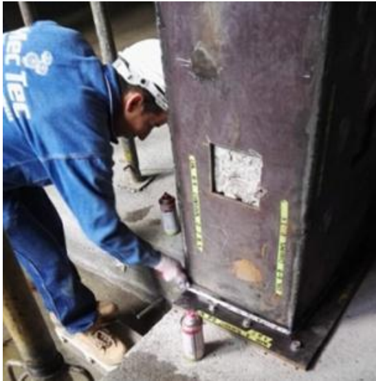
Ilustración 62 Aplicación del aerosol revelador en la arista de la columna.
