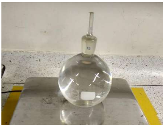
Ilustración 22. Picnómetro con agua
