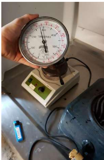
Ilustración 21. Ejecución ensayo de punto de inflamación y combustión Fuente: Propia
