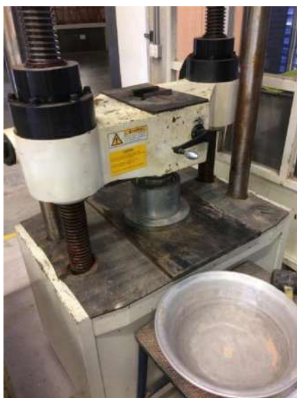
Ilustración 5. Ensayo de 10% de Finos en Ejecución Fuente: Propia
