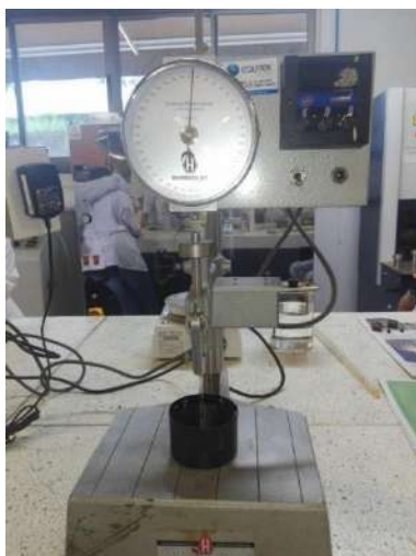
Ilustración 17. Ensayo de penetración en ejecución.
