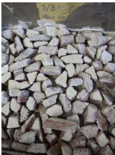
Ilustración 6. (Izquierda) Ensayo de Solidez en Agregado Cerámico
