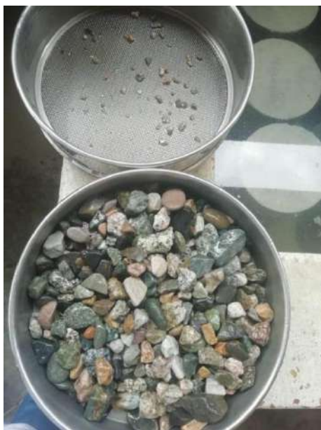
Ilustración 8. Lavado de Material para Llevar a Cabo el Ensayo de Limpieza Superficial. Fuente: Propia
