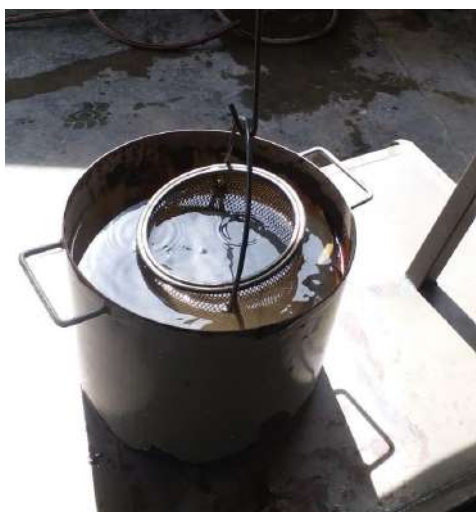
Ilustración 16. Ensayo de Densidad de Agregado Grueso Fuente: Propia
