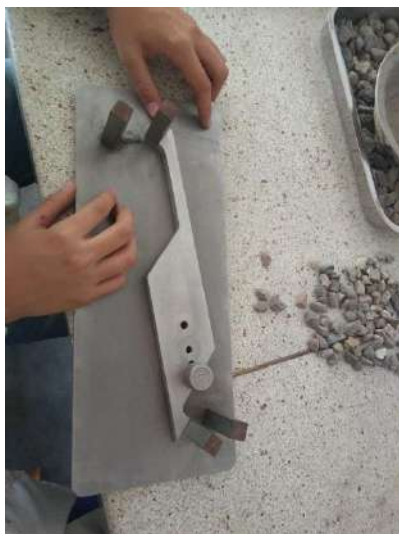
Ilustración 11. Ensayo de Caras Planas, Alargadas o Planas y Alargadas en Ejecución
