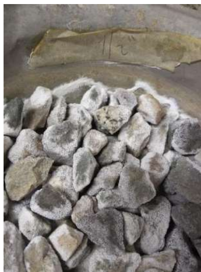
Ilustración 6. (Izquierda) Ensayo de Solidez en Agregado Cerámico
