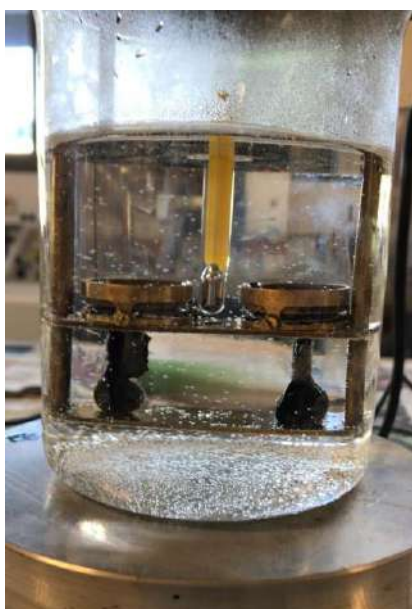
Ilustración 18. Caída de las Esferas en la Lámina de Referencia Punto de Ablandamiento Fuente: Propia
