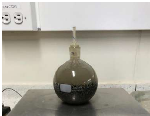
Ilustración 14. (Izquierda) Ensayo de Densidad de Finos con Agregado Natural
