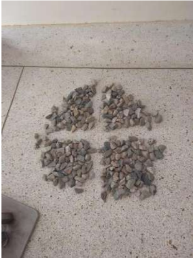
Ilustración 12. Cuarteo de material para el ensayo de partículas fracturadas Fuente: Propia
