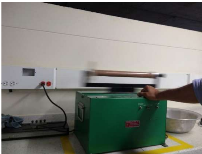
Ilustración 10. Ensayo de Equivalente de Arena en Ejecución Fuente: Propia
