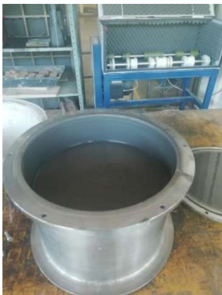
Ilustración 4. Molde y Máquina Ensayo Micro-Deval Fuente: Propia
