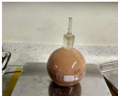
Ilustración 14. (Izquierda) Ensayo de Densidad de Finos con Agregado Natural
