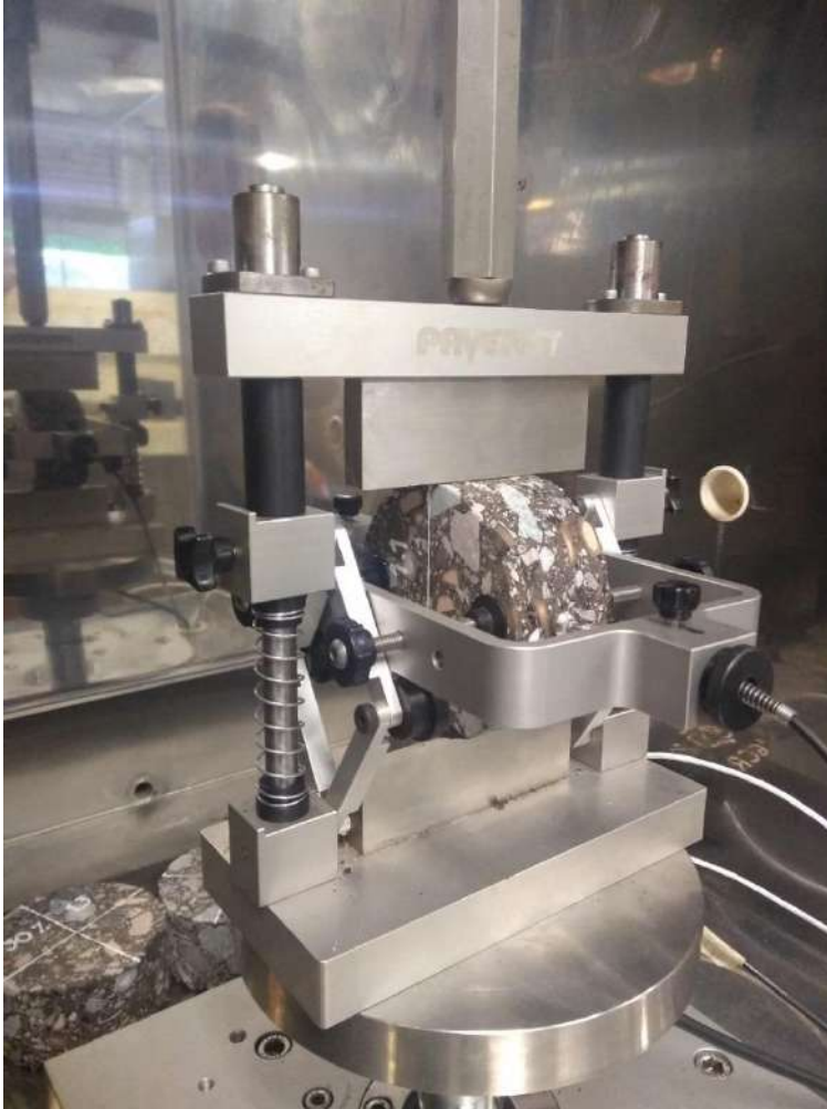
Ilustración 28. Montaje ensayo de Módulos Resilientes Fuente: Propia
