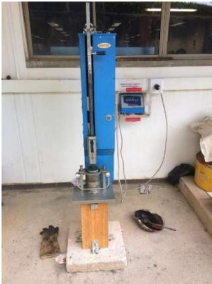
Ilustración 25. Compactador Mecánico Método Marshall
