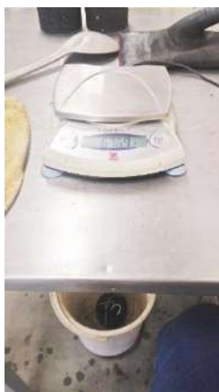
Ilustración 23. Briqueita Sumergida (Determinación de la Densidad Bulk)
