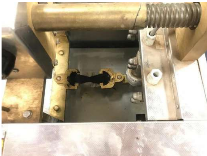
Ilustración 20. Inicio del Ensayo de Ductilidad
