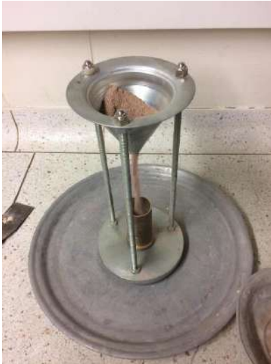
Ilustración 13. Ensayo de Angularidad de Finos con Material Cerámico en Ejecución
