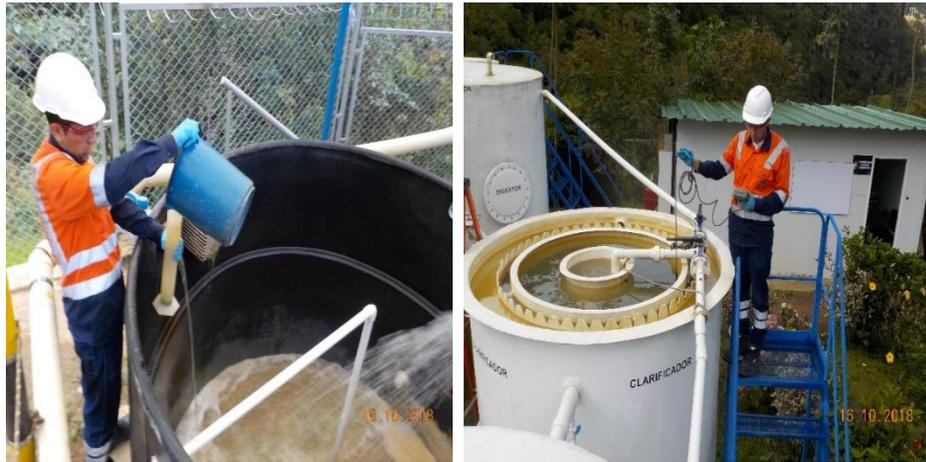
*Figura 11. Aforo y toma de parámetros IN-SITU en la PTARD. Fuente: Autor.*
