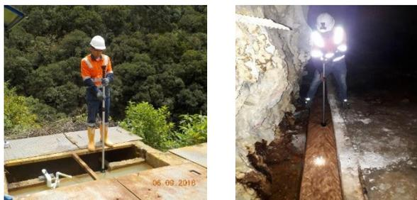
*Figura 9. Aforo de caudal del afloramiento natural de agua. Fuente: Autor.*
