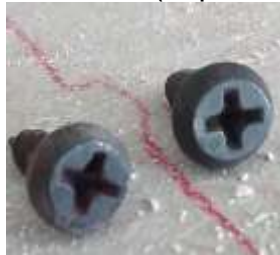
Figura 72. Ejemplo de tornillos cortos, tornillo original de drywall (Derecha), tornillo defectuoso (Izquierda)
