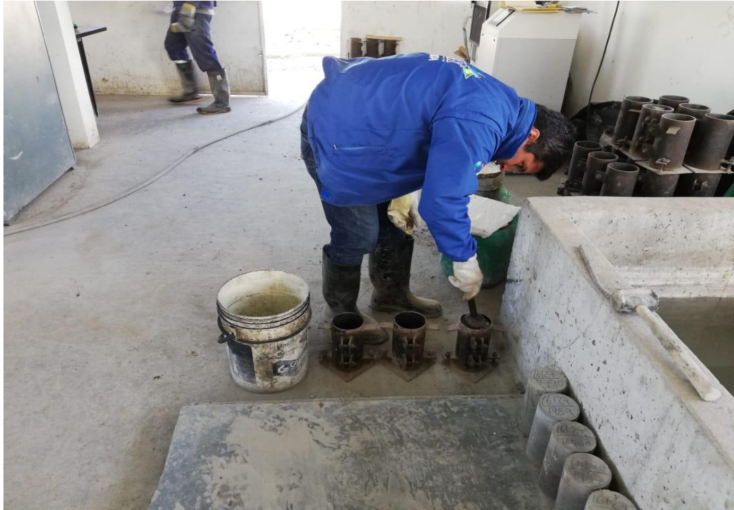
Ilustración 9. Muestras en Concreto de Laboratorio Según NTC-550
