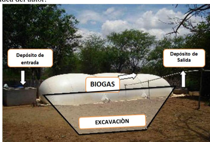
Figura 24. Modelo del biodigestor. Esquema pictórico que representa la idea del autor.
