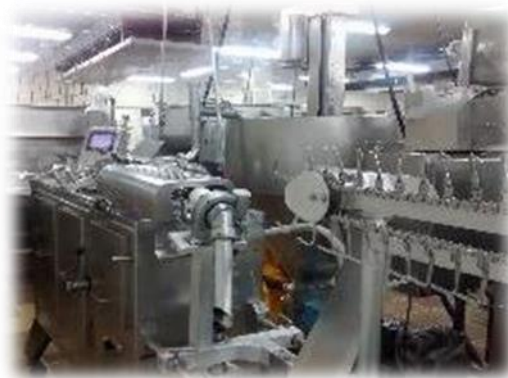
Ilustración 4: Embutidora de salchichas RT6
