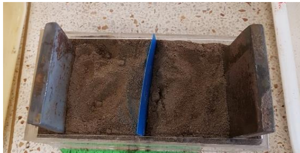
Figura 22. Electroodos insertados en el suelo
