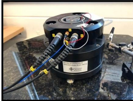
Como resultado las pruebas realizadas a los sensores ADXL mostraron que no eran los suficiente confiables cuando se operaban por encima de los 400 Hz como se muestra en la figura 31, 32 y 33, dando una lectura no exacta y también se observa que a medida que la frecuencia aumenta la sensibilidad disminuye de una manera no lineal, la variación no es consistente a distintas amplitudes. (tabla 1). En consecuencia, se decidió utilizar sensores acelerómetros convencionales IEP (figura 33).
