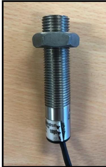
El sensor OROS referencia OTAC-TAC-O01 mide por medio de pulsos y tiene una salida BNC, este se adecuo por medio de una placa para que realizara la medición de los RPM de la máquina.
