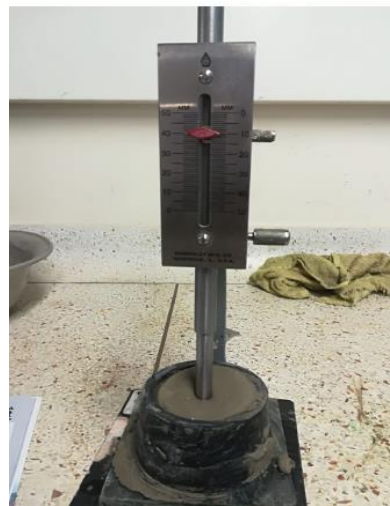
Ilustración 11. Ensayo de consistencia normal del cemento.
