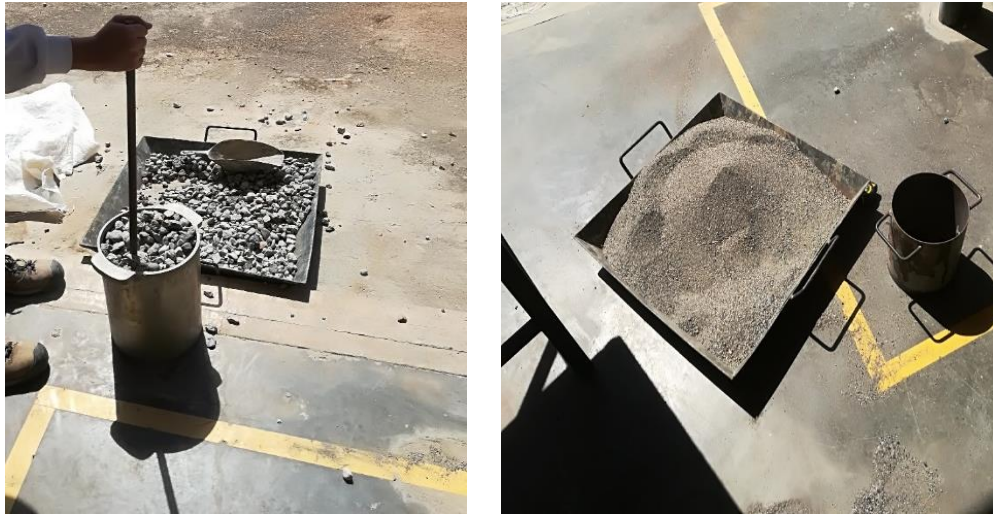
Ilustración 5. Masa unitaria suelta y compacta de agregados.
