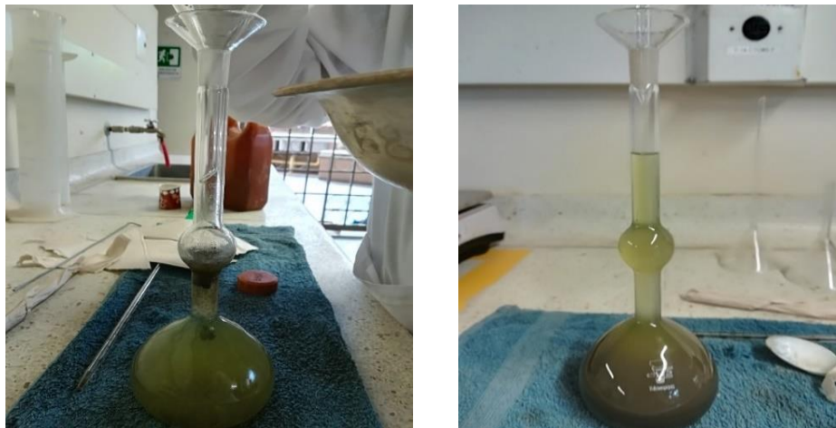
Ilustración 10. Ensayo densidad del cemento.
