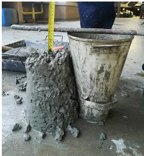
Ilustración 13. Ensayo de asentamiento.
