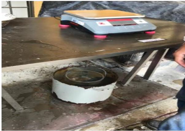
Ilustración 7. Ensayo densidad del agregado grueso.
