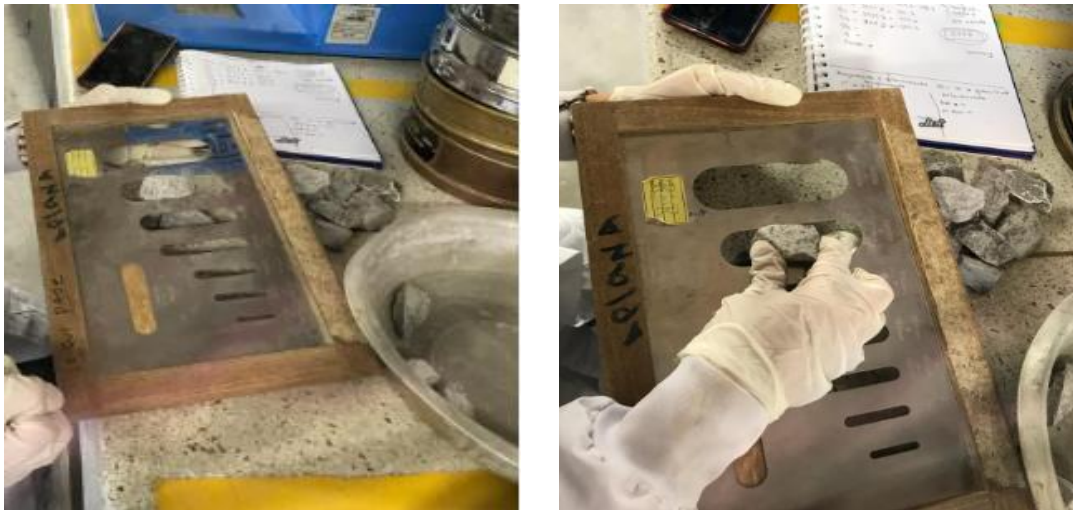
Ilustración 6. Ensayo alargamiento del agregado grueso. Fuente: Propia.
