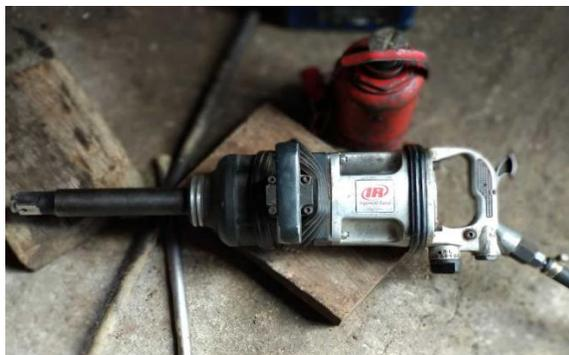
Figura 7. Pistola Neumática. *Fuente: Empresa Track Repuestos*
