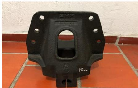
Figura 2. Soporte Suspensión Kenworth. *Fuente: Empresa Track Repuestos*
