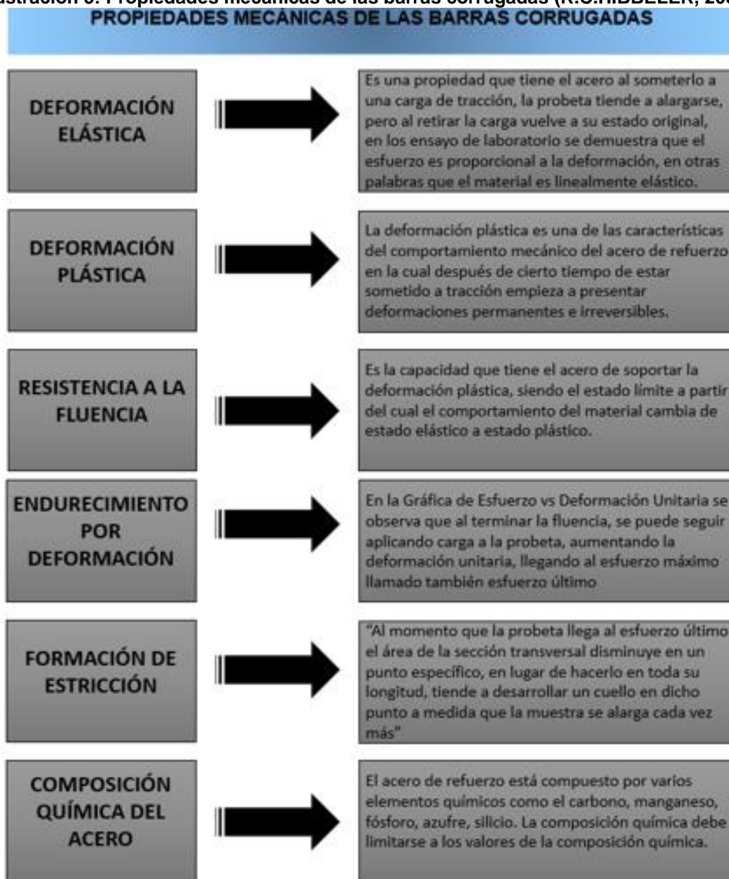
Ilustración 5: Propiedades mecánicas de las barras corrugadas (R.C.HIBBELER, 2006)
