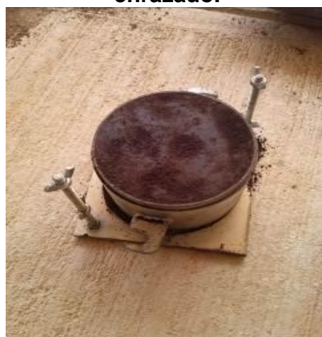
Figura 29 : se puede observar un próctor terminado, debidamente enrazado.
