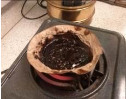
Figura 23: Proceso para determinar la humedad del material
