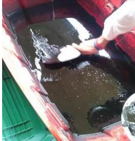
Figura 61 : Extracción de una muestra del material contaminado al 100%
