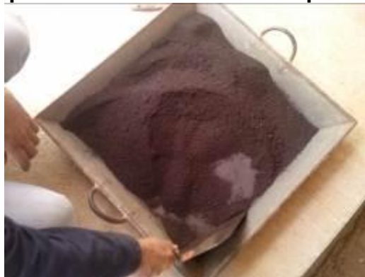
Figura 26: Mezclado del material con el porcentaje de agua determinado para alcanzar la humedad óptima
