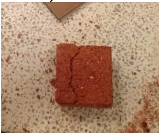
Figura 35 : Muestra fracturada después de haberse realizado el ensayo de corte directo
