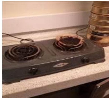
Figura 24: Determinación de la humedad del suelo mediante el uso de la estufa eléctrica
