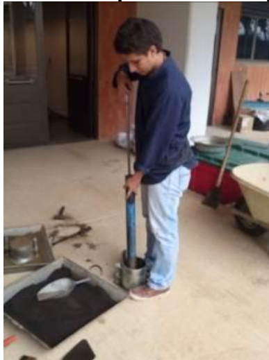
Figura 28 : se muestra la compactación del próctor modificado.
