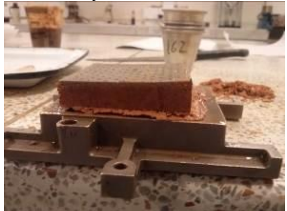
Figura 34: Muestra vista desde el lado lateral , después de salir del ensayo de corte directo
