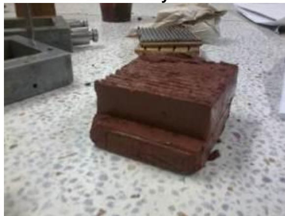
Figura 36 : Como debe quedar la muestra al salir del molde de la máquina de corte directo, al terminar el ensayo
