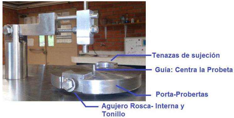
Figura 3. Diseño final del sistema de sujeción
