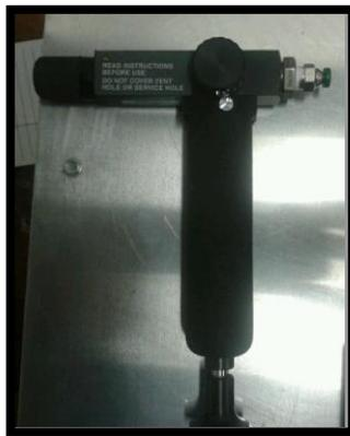
Figura 70. Bomba de presión Fluke serie 700 LTP.
