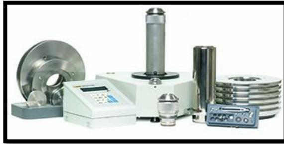
Figura 29. Manómetro de pistón [30]
