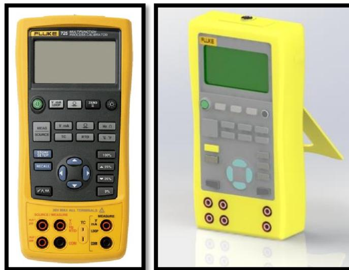
Figura 45. Imagen Izquierda, Calibrador de procesos Fluke 726 [45], Imagen derecha, renderizado calibrador de procesos 726.
