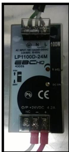
Figura 44. Fuente externa de 24 Vdc, EBCHQ, LP1100D-24M
