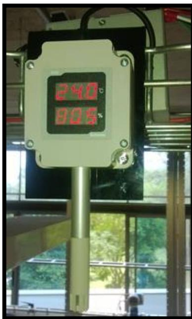
Figura 30. Transmisor de temperatura y humedad.
