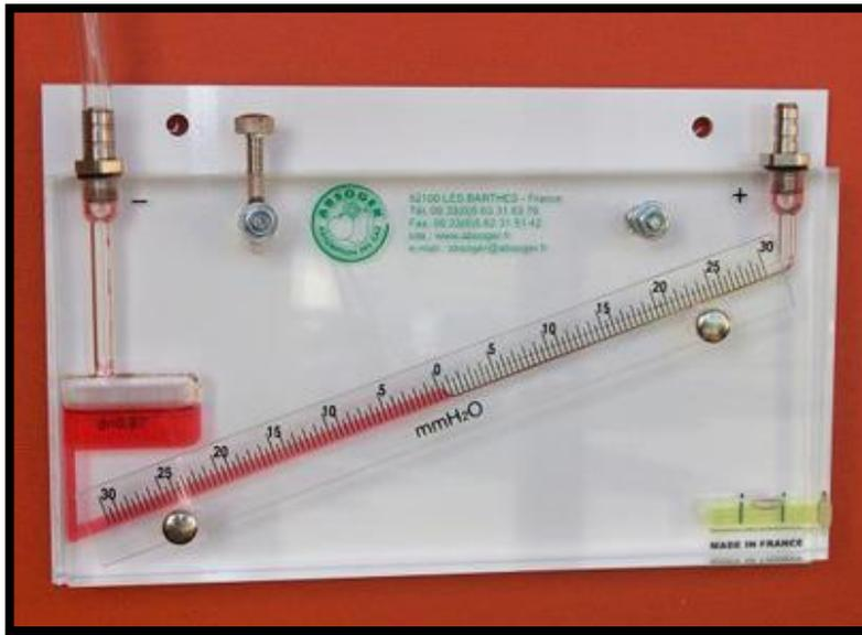
Figura 6. Manómetro de tubo inclinado [53]
