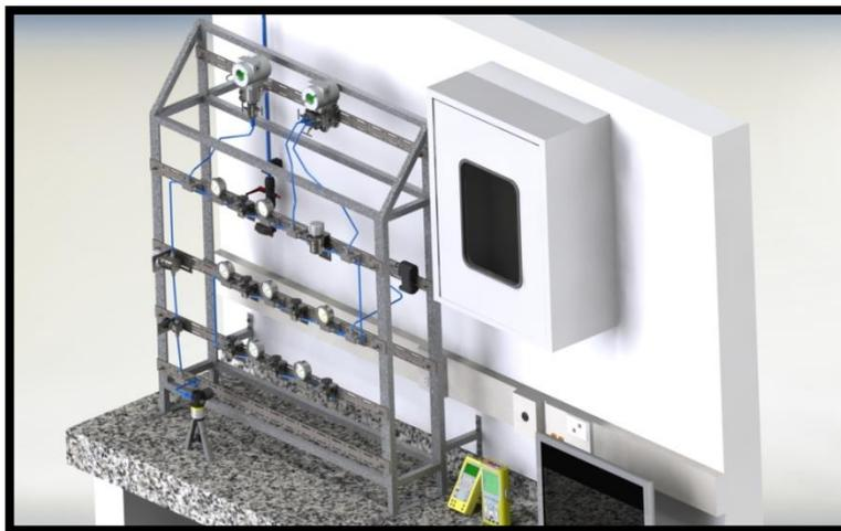
Figura 50. Renderizado final del módulo de presión.
