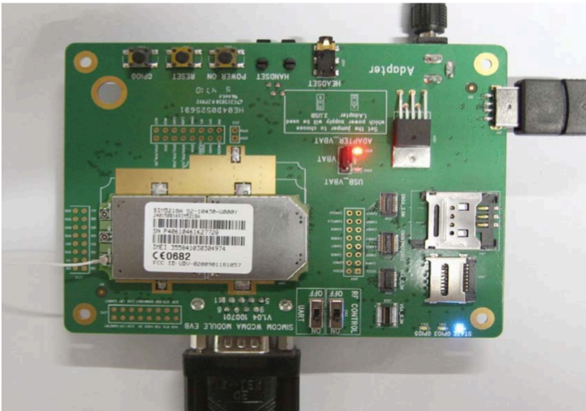
Figura 53. Kit de desarrollo del módulo de comunicación celular
