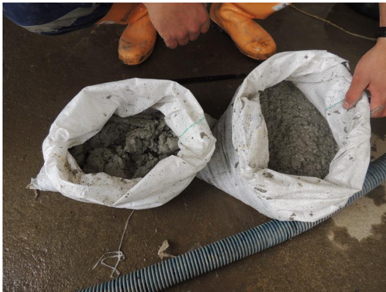
FOTOGRAFÍA No: 18 LUGAR: Bodega OBSERVACIONES: Ensayos de optimización en la reducción contenido de agua de los lodos de perforación
