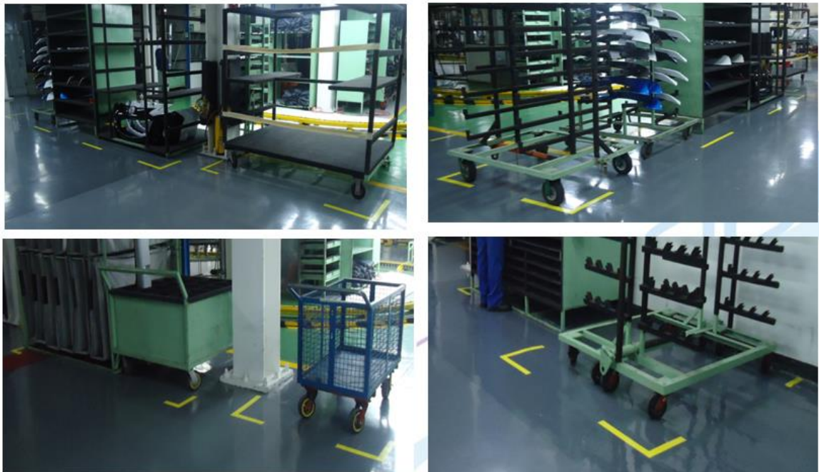
Imagen 16. Marcado con cinta de seguridad en Cámara-2.
