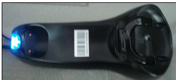
Figura 24. Receptor/Base de Carga del Lector – Fuente: Autor [12]
