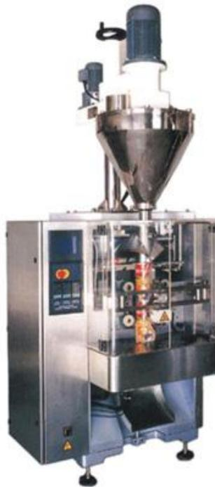
Figura 3. Máquina neumática vertical para productos en polvo [1]
