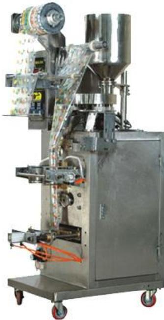
Figura 2. Máquina neumática vertical para productos sólidos [1]
