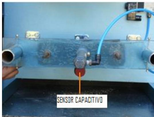
Figura 117. Ubicación del sensor capacitivo. Fuente autor
