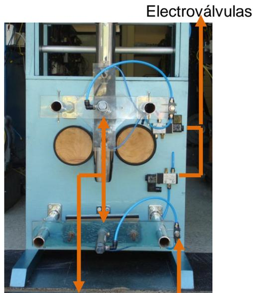
Cilindros neumáticos. Regulador de presión
