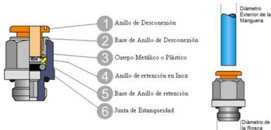
Figura 42. Características técnicas de un racor. [48]
