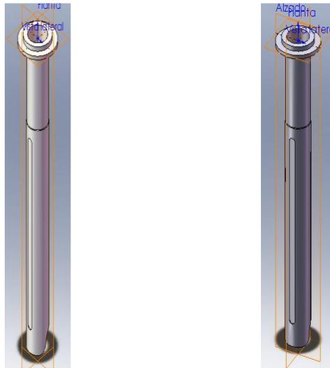
Figura 85. Vistas del tubo formador. Fuente autor
