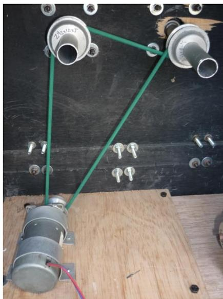
Figura 116. Mecanismos de poleas y banda transmisora redonda. Fuente autor
