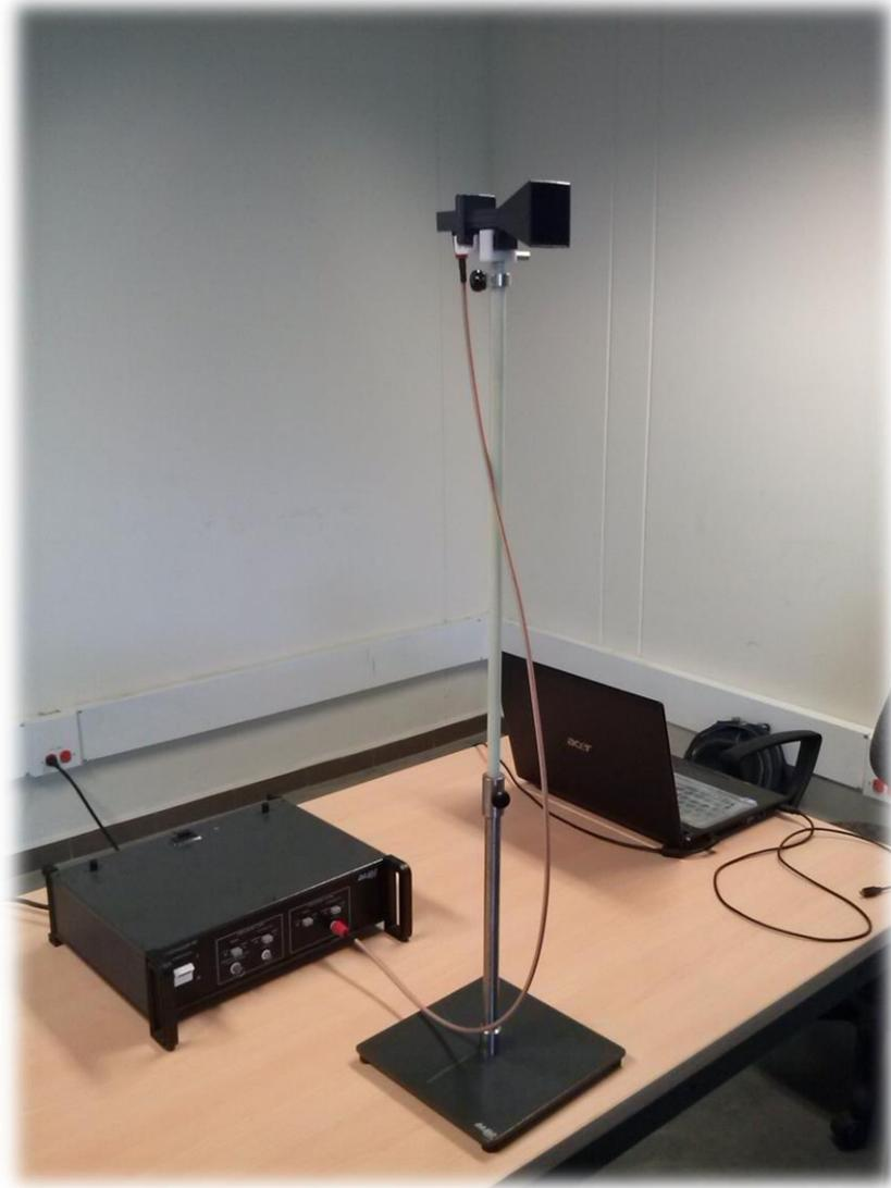
La antena parche rectangular se ubicó en el mástil, conectando el cable SubMiniature versión A (SMA) entre el orientador y la antena como se muestra en la (figura 74).
