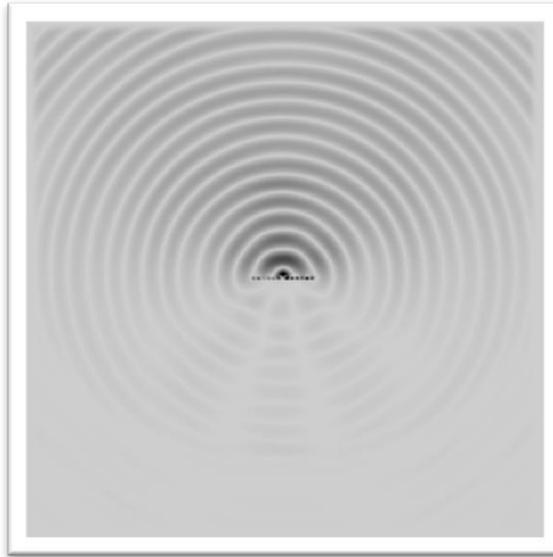
En las (figuras 103, 104 y 105) se presentan las simulaciones con el total de iteraciones, como se ve estas las radiaciones ocupan toda la grilla de simulación. Se observa como la capa de absorción no refleja las ondas en ninguno de los campos simulados.
