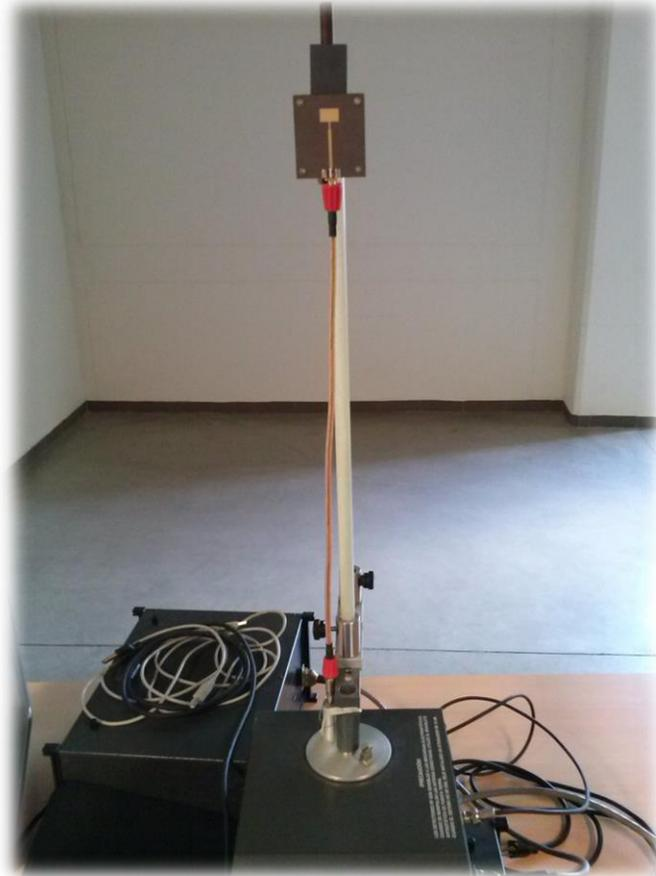
La antena parche rectangular se coloca como receptora debido a que el software de lab-Volt mide el patrón de radiación de la antena receptora.
