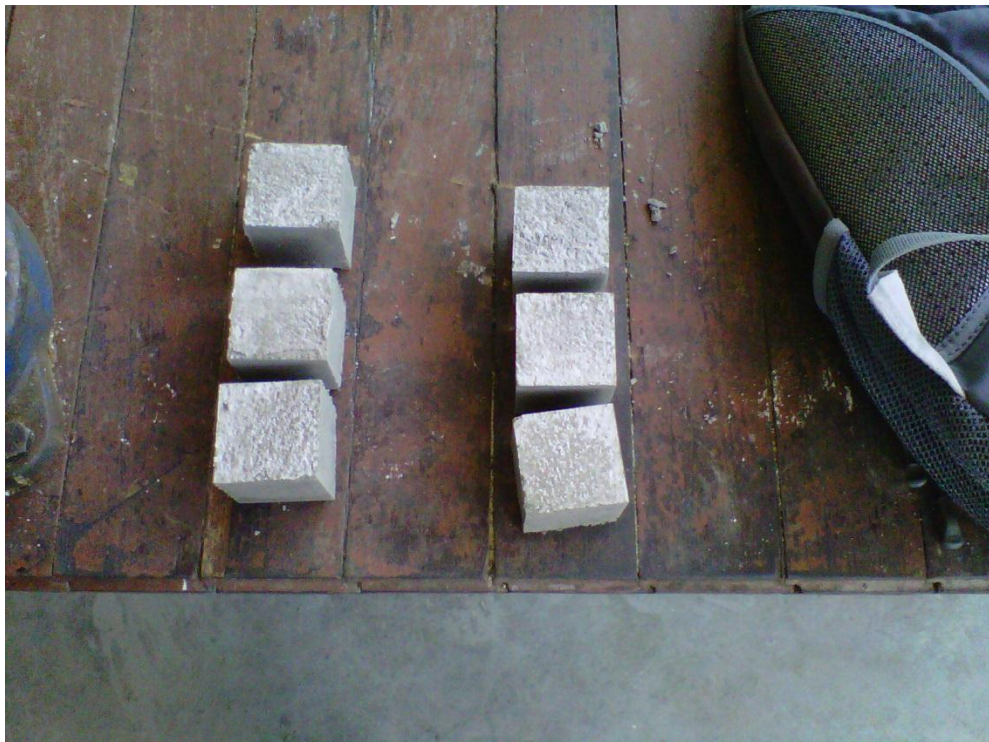
Cubos de morteros desencofrados.
