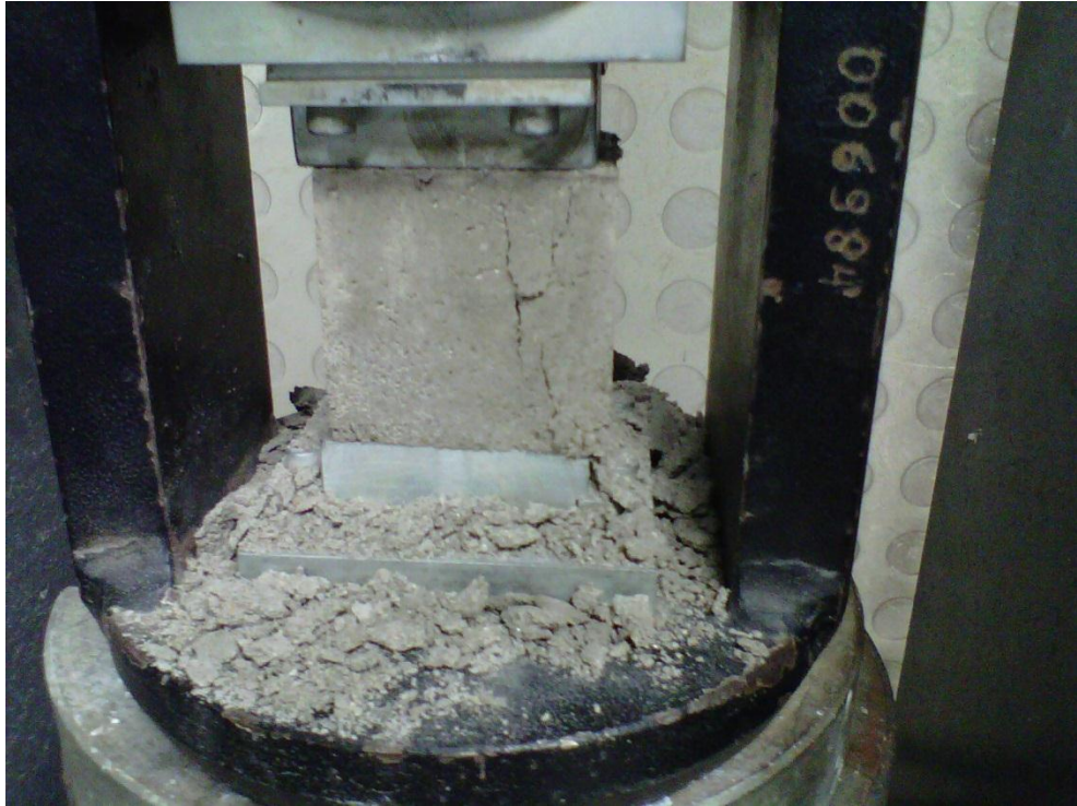
Probeta ensayada y tipo de falla
