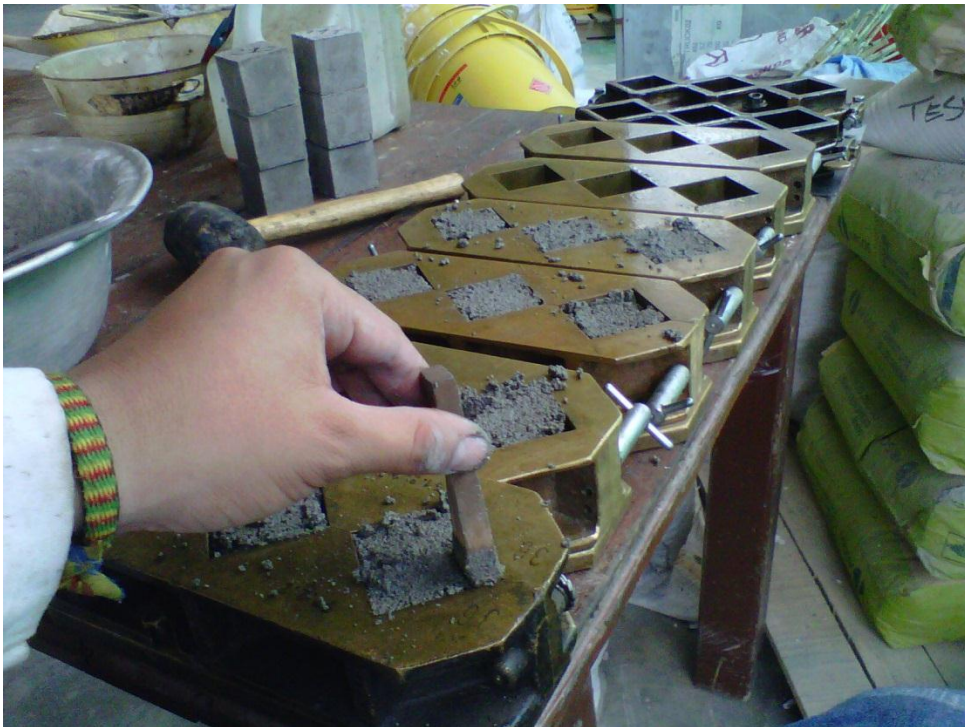
Compactación del mortero.
