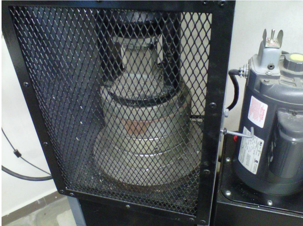
Armado de prensa hidráulica y mordaza para ensayar los cubos de mortero.
