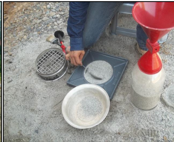
Imagen 74. Toma de densidades con cono de arena
