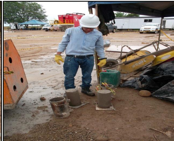
Imagen 17. Cilindros de prueba RH1
