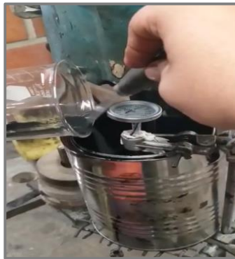
Figura 1. Asfalto a 165°C con adición de masa negra.
