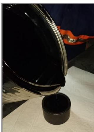
Figura 3. Muestra en molde definido por la norma INV E-706
