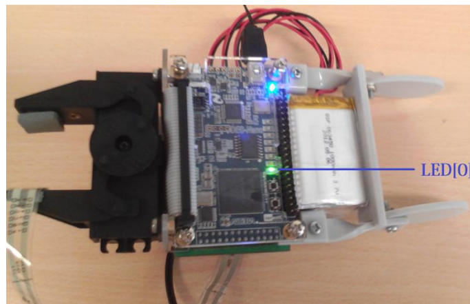
Figura 64. LED[0] encendido indicando que el algoritmo se encuentra en control de fuerza.
