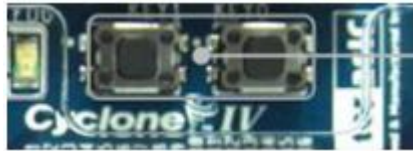
Figura 26. Pulsadores KEY[0] y KEY[1] de la DE0-Nano para modificar el ajuste de la señal de electromiografía.
