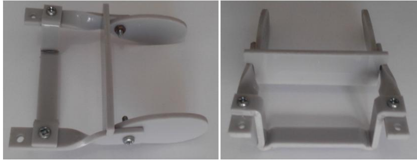
Figura 48. Piezas para el sostén de las baterías, y enganche de la prótesis a un muñón.
