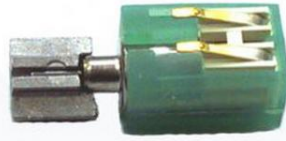
Figura 33. Vibrador seleccionado como interfaz háptica.
