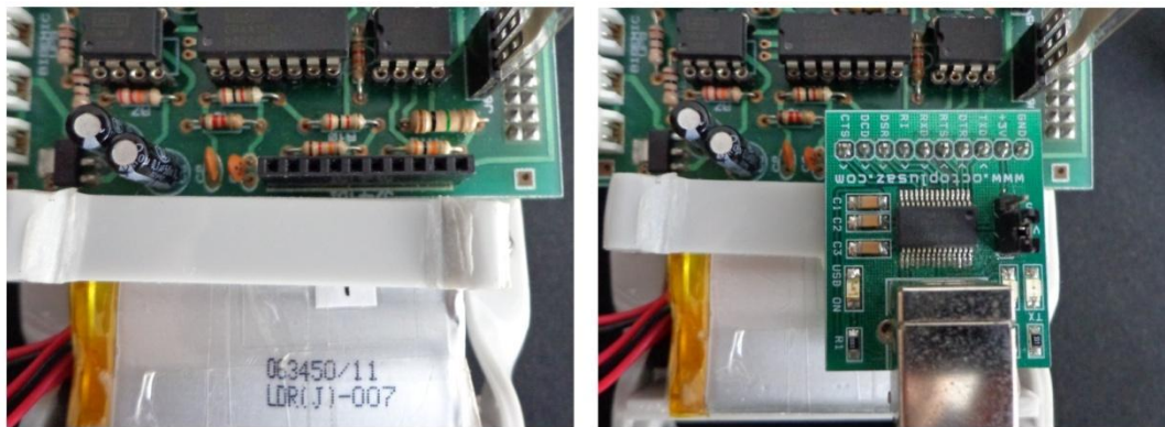
Figura 11. Conexión del módulo de comunicación serial.
