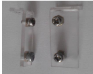
Figura 46. Piezas para acoplar la DE0 Nano y el gripper
