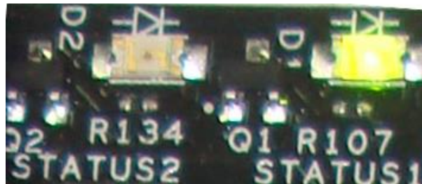
Figura 15. LEDs status de la tarjeta de desarrollo
