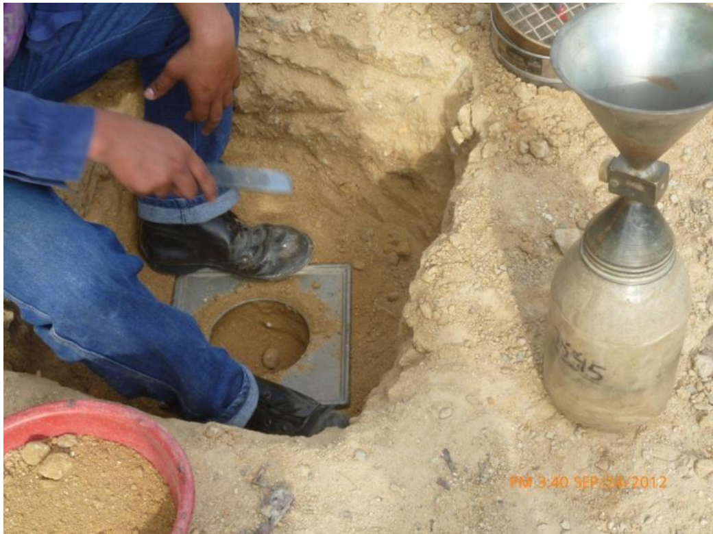
Figura 67 Ensayo de Densidad Pr 135-Pr 134
