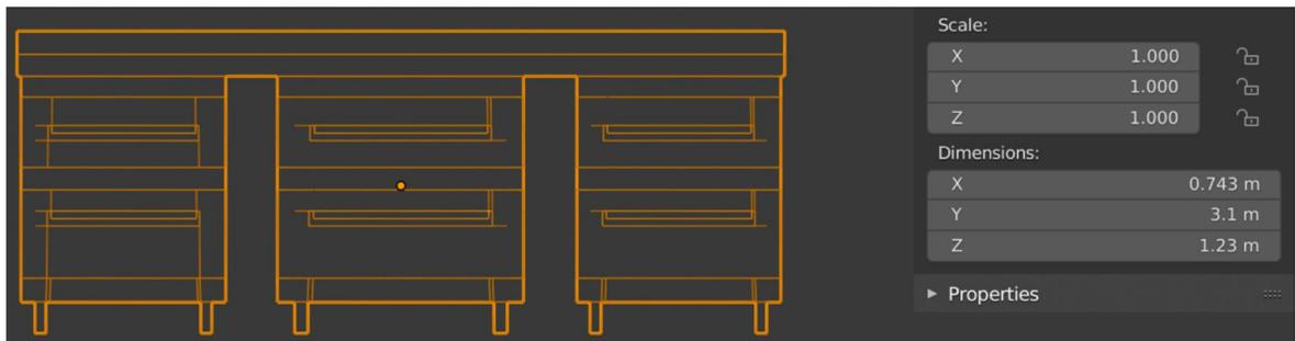
Ilustración 14. Dimensiones del modelo en Blender
