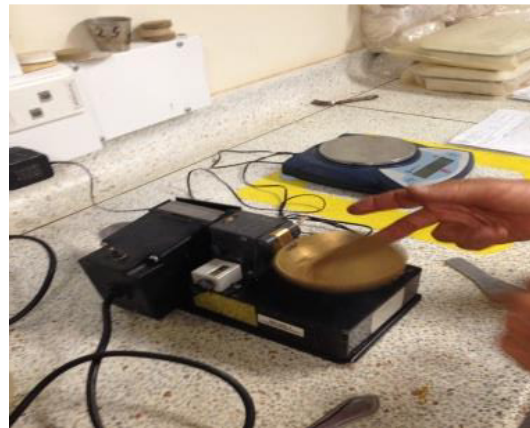
Foto 5 - Ensayos de límite liquido de los suelos.
