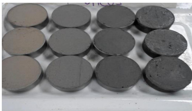
Foto No. 06 - Ensayo límite de contracción.
