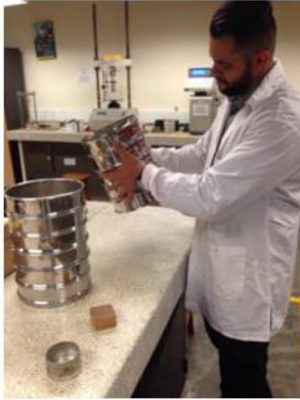
Foto 1 - Realización de Ensayos de Tamizado (Granulometría)
