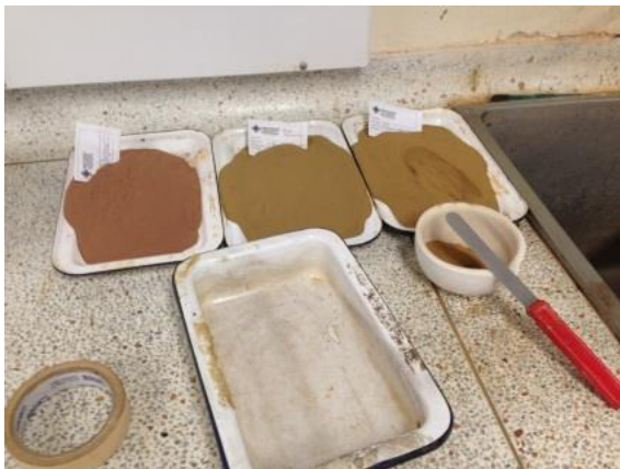
Foto 5 - Ensayos de límite liquido de los suelos.
