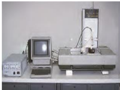
Imagen 2: Imagen de la primera máquina de prototipado creada por Chuck Hull
