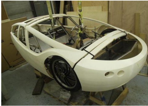
Imagen 4: Armazón del carro Urbee impreso en 3D
