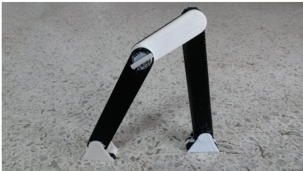
Imagen 43: "Mecanismo doble balancín de Grashof" en pie
