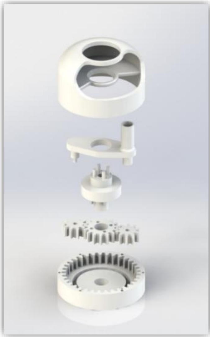
Figura 47. Vista explosionada de sistema epicicloidal, prototipo final.
