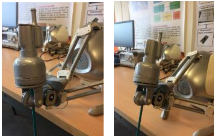
Figura 125. Prueba de ubicación y funcionamiento de los subsistemas de engranes para la medición de los movimientos.
