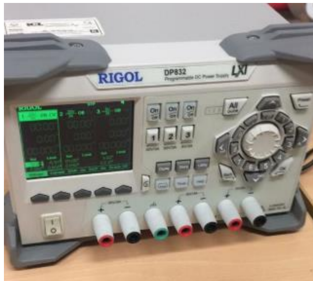
Figura 119. Fuente de poder utilizada para alimentar los motores en las pruebas de funcionalidad.
