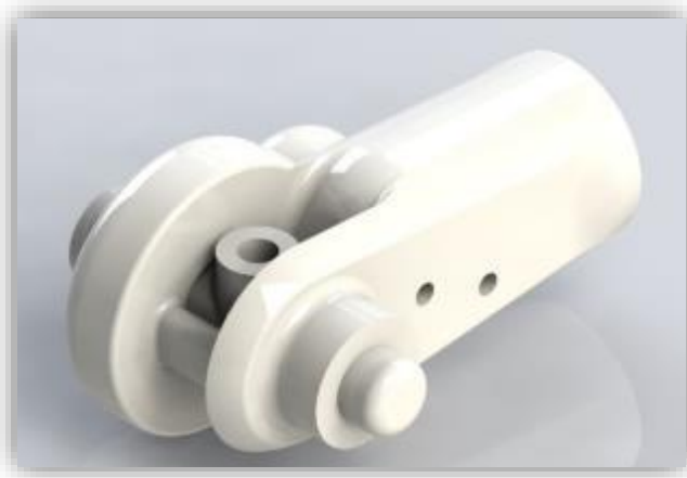
Figura 38. Boceto Isométrico brazo conexión, prototipo final.
