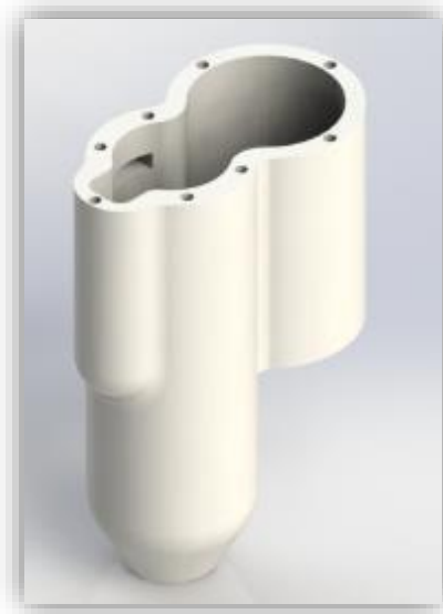
Figura 51. Vista isométrica de cobertura porta pinza, prototipo final.
