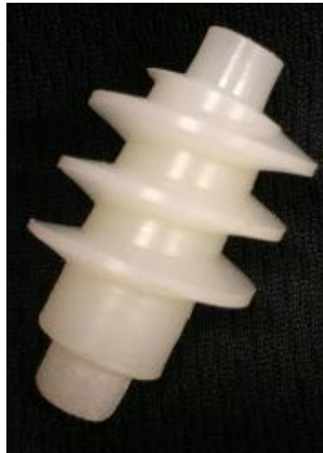
Figura 116. Tornillo sin-fin mecanizado en material de teflón.
