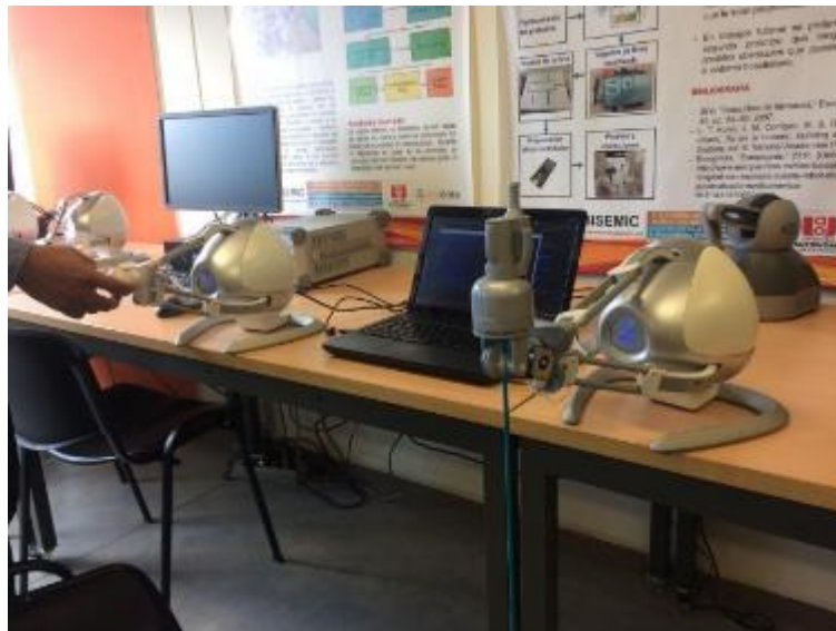
Figura 124. Prueba de levantamiento de la Novint Falcon, Punto extremo frontal.
