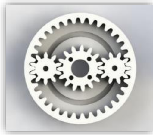
Figura 43. Vista superior de sistema epicicloidal, prototipo final.
