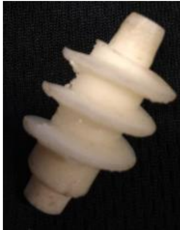
Figura 115. Tornillo sin-fin fabricado por medio de impresión 3D en PLA.
