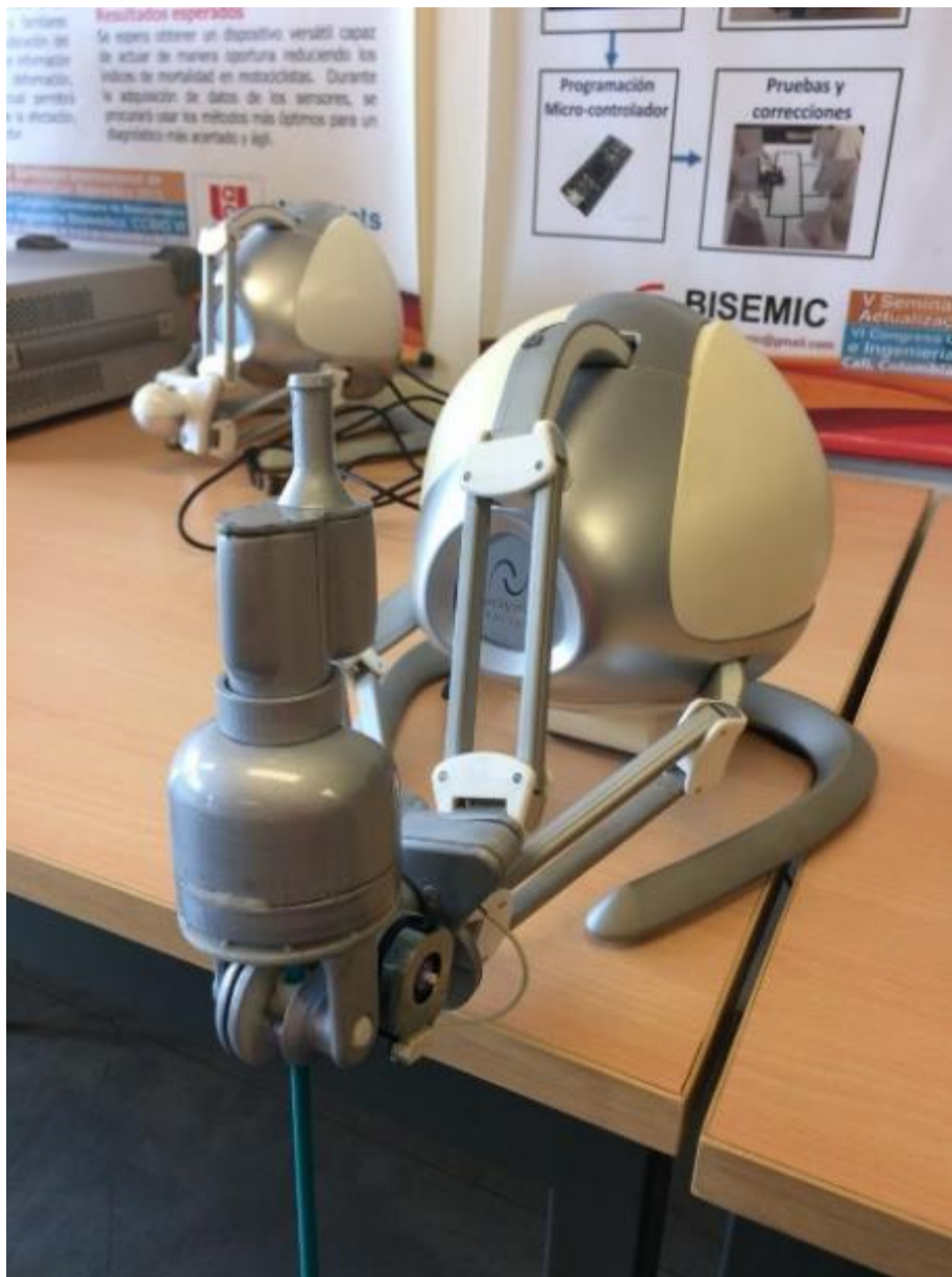
Figura 117. Registro fotográfico 1 de la instalación final del prototipo sobre la interfaz háptica Novint Falcon.
