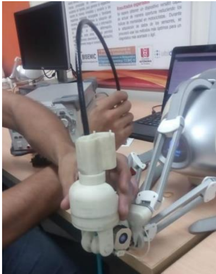
Figura 120. Prueba de funcionalidad motriz del sistema epicicloidal.
