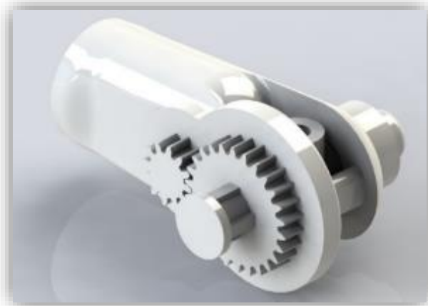
Figura 35. Vista isométrica conexión del subsistema de engranes al pasador guía, prototipo final.
