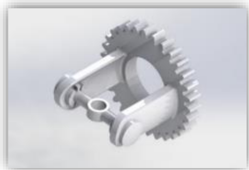
Figura 21. Isométrico del ensamble del soporte giratorio y de la porta pinza del prototipo inicial.
