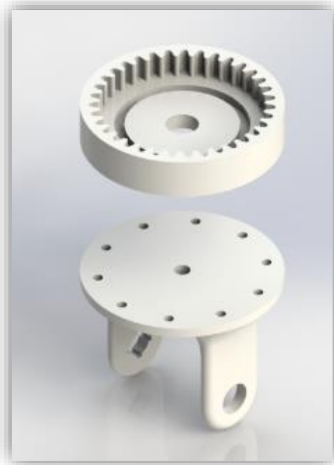
Figura 41. Separación de la corona del sistema epicicloidal de la base, prototipo final.
