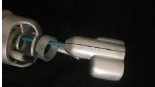
Figura 112. Séptimo paso de construcción, ensamble de coberturas superiores de la porta pinza.
