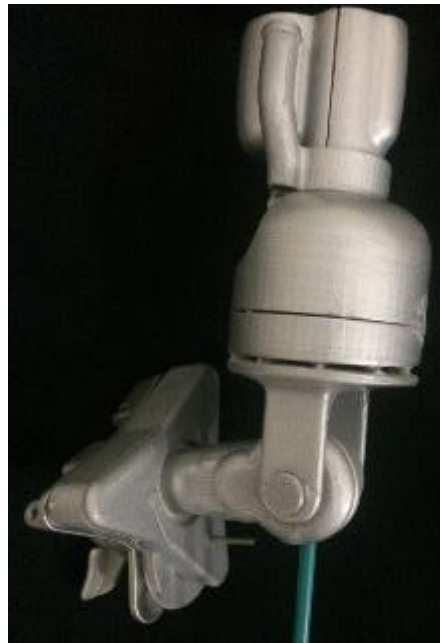
Figura 114. Noveno paso de construcción, acople de todo el sistema epicicloidal con porta pinza.
