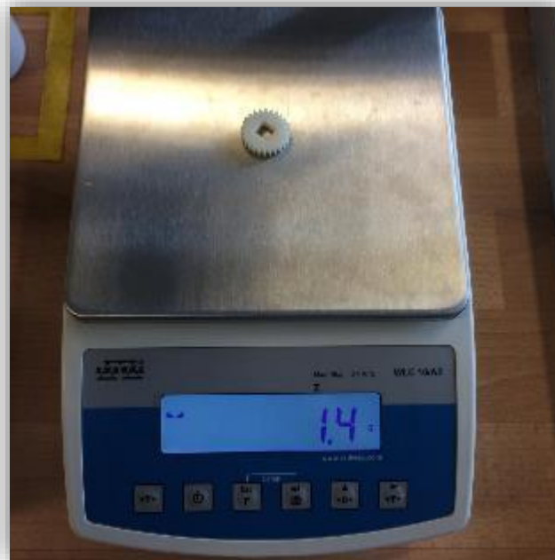
Figura 103. Ejemplo de toma de datos de peso real de las piezas obtenidos en el laboratorio de instrumentación.
