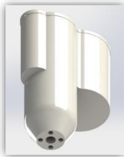
Figura 52. Vista perspectiva inferior de ensamble porta pinza, prototipo final.
