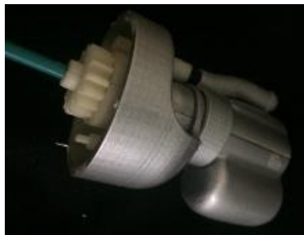
Figura 113. Octavo paso de construcción, acople de sujetadores desde la vista inferior de la porta pinza.
