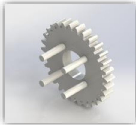
Figura 28. Boceto isométrico soporte giratorio 1, prototipo final.
