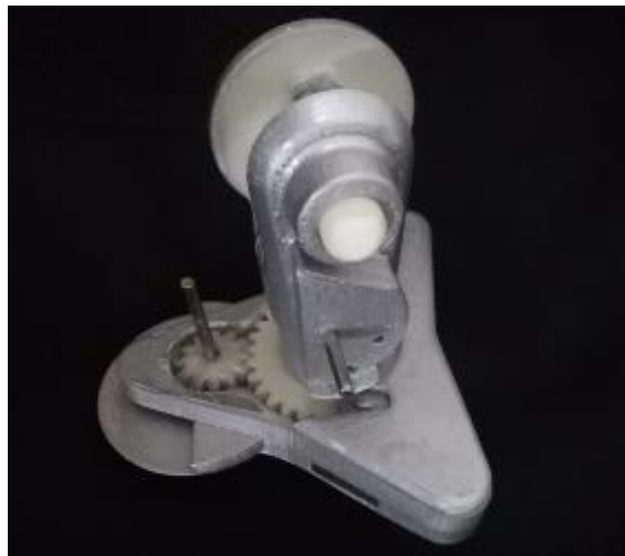
Figura 107. Paso 2 de construcción, ensamble de Base con soporte giratorio.
