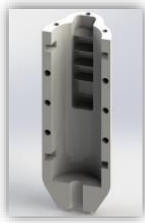
Figura 54. Vista isométrico segunda parte de la cobertura del portapinzas, prototipo final.
