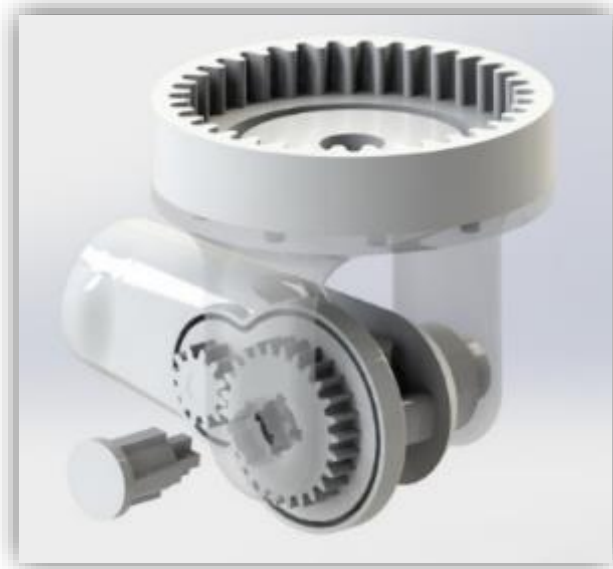
Figura 42. Conexión entre pasador guía, subsistema de engranes y corona base, prototipo final.
