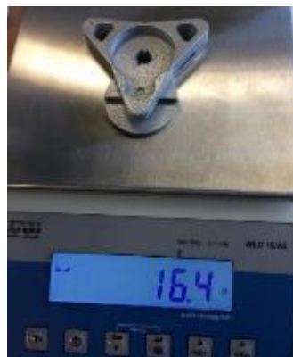
Figura 104. Ejemplo de toma de datos para las piezas luego del proceso de pintura.
