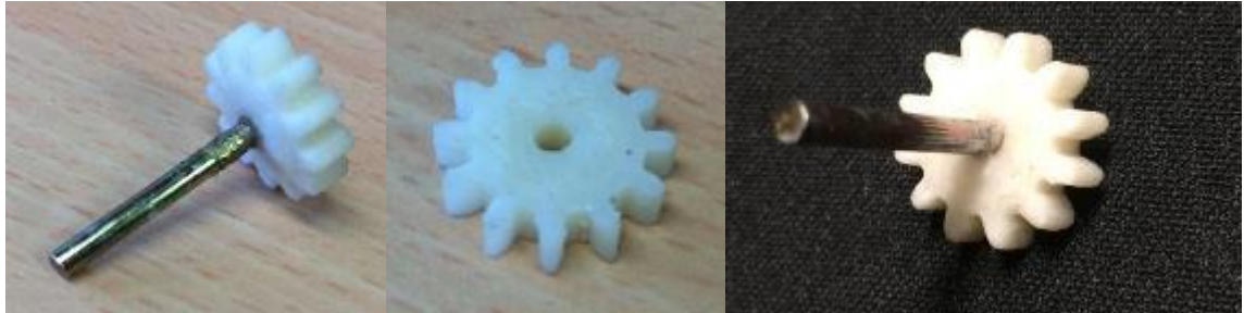
Figura 105. Proceso de construcción de ejes para subsistemas de engranes.
