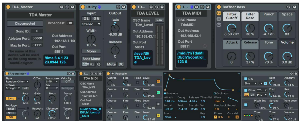
Figura 6. Racks de instrumentos, sintetizador y efectos en Ableton Live. junto con los plugins de Max4Live que permiten la conexión con TDableton.
