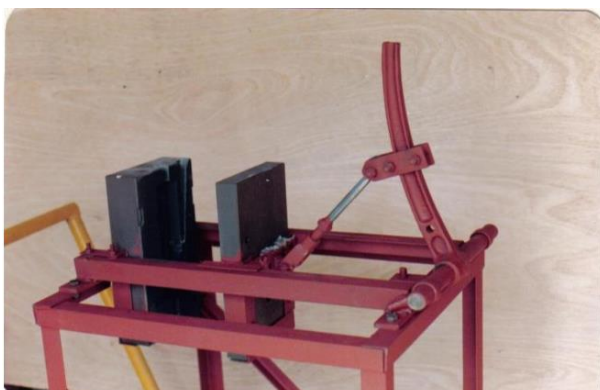
Ilustración 17. Sistema de manipulación de la coquilla para facilitar su ensamble y desensamble. Fuente: Florez, D; Arenas J. (S.f.). Moldeo Metálico por Gravedad para la Manufactura de una Biela de Bicicleta.
