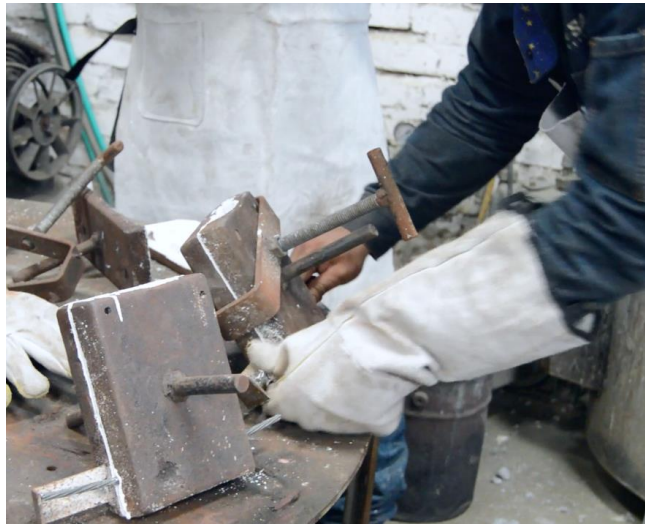
Ilustración 5. Ensamble de coquillas.
