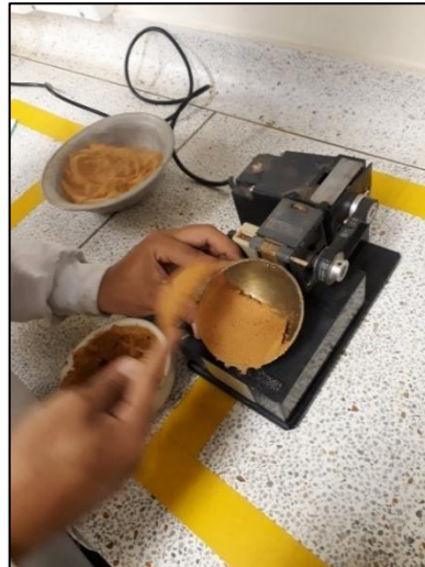
Ilustración 36. Colocación de la mezcla de suelo dentro de la cazuela.
