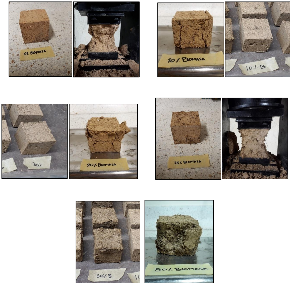
Ilustración 62. Especímenes fallados a compresión, Bagazo tipo B.
