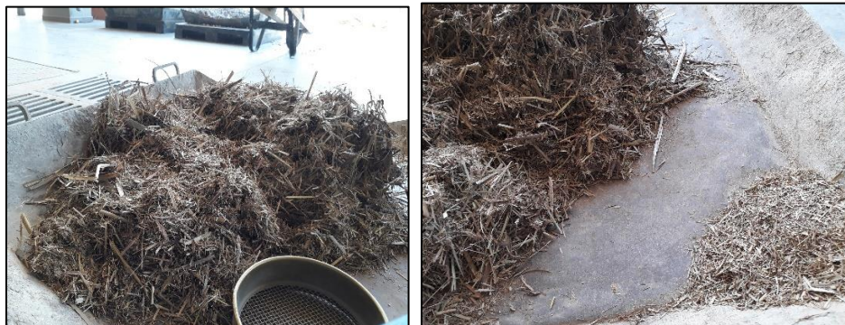
Ilustración 47. Cernida del material triturado.
