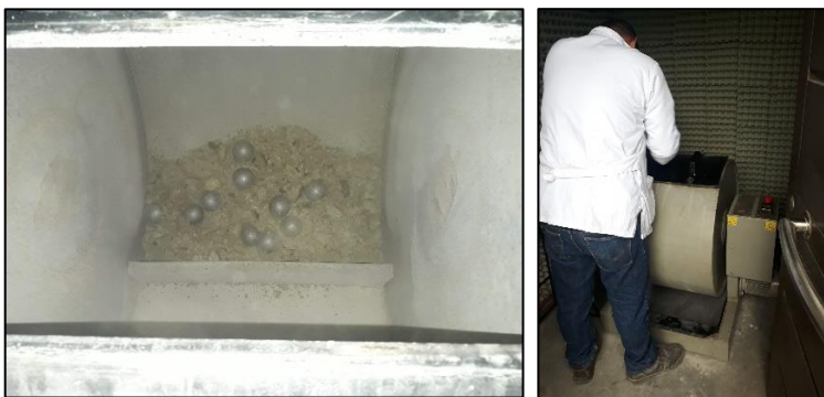
Ilustración 49. Trituración en la máquina de los ángeles (Bagazo tipo B).
