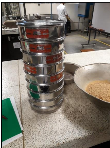
Ilustración 30. Serie de tamices para granulometría.
