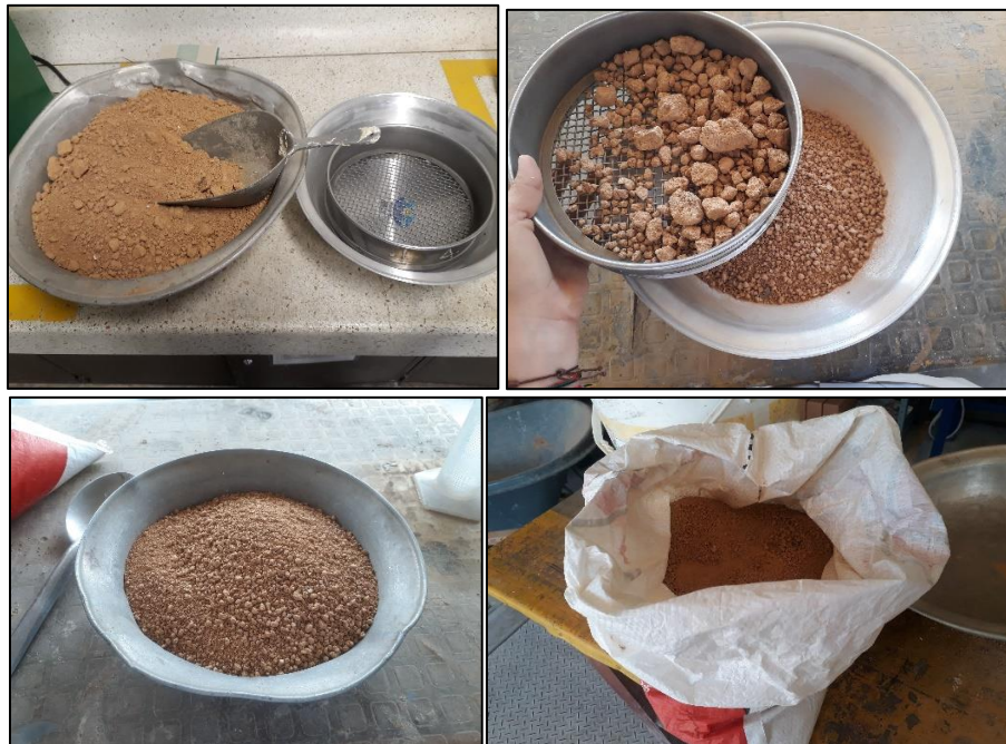
Ilustración 44. Tamizado de la materia prima.
