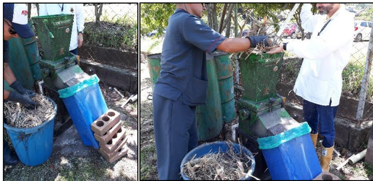
Ilustración 46. proceso de triturado de bagazo tipo A.
