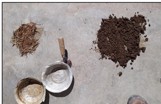
Ilustración 52. Secado superficial del bagazo (tipo A y tipo B)
