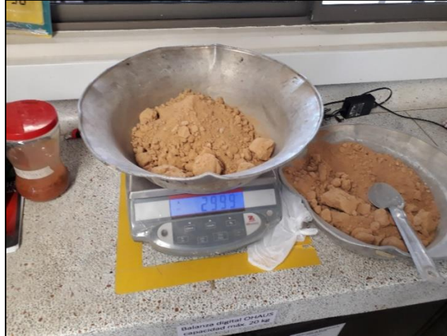
Ilustración 33. Muestra de suelo para ensayo de limite líquido y plástico.
