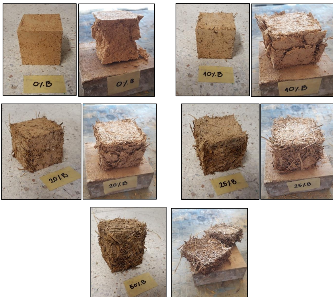
Ilustración 61. Especímenes fallados a compresión, Bagazo tipo A.
