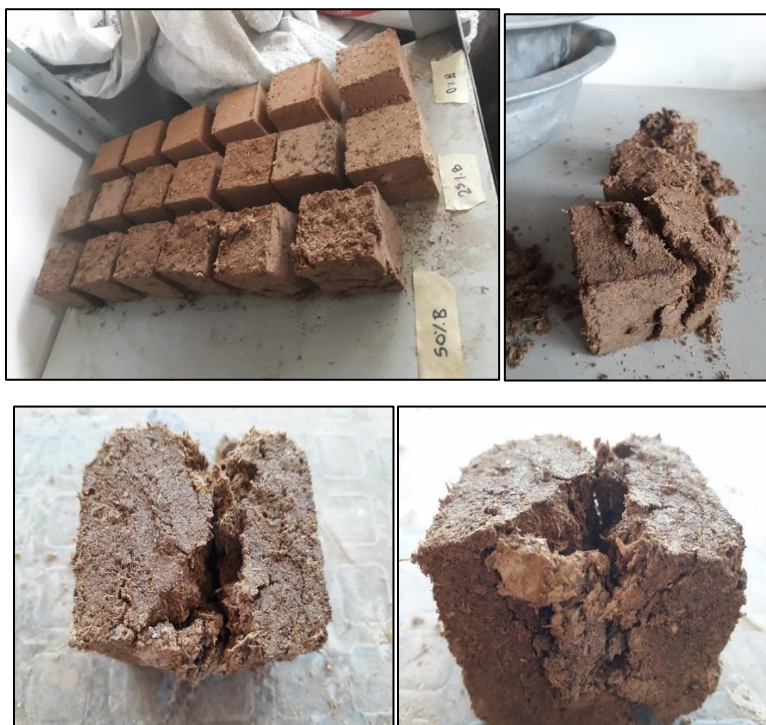
Ilustración 58. Especímenes con alteraciones (Bagazo tipo A)
