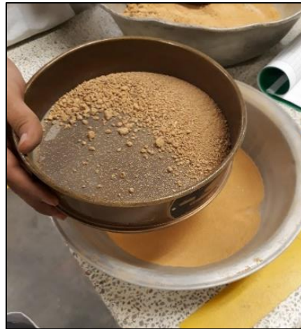
Ilustración 34. Muestra de suelo tamizada para ensayo de limite líquido y plástico.
