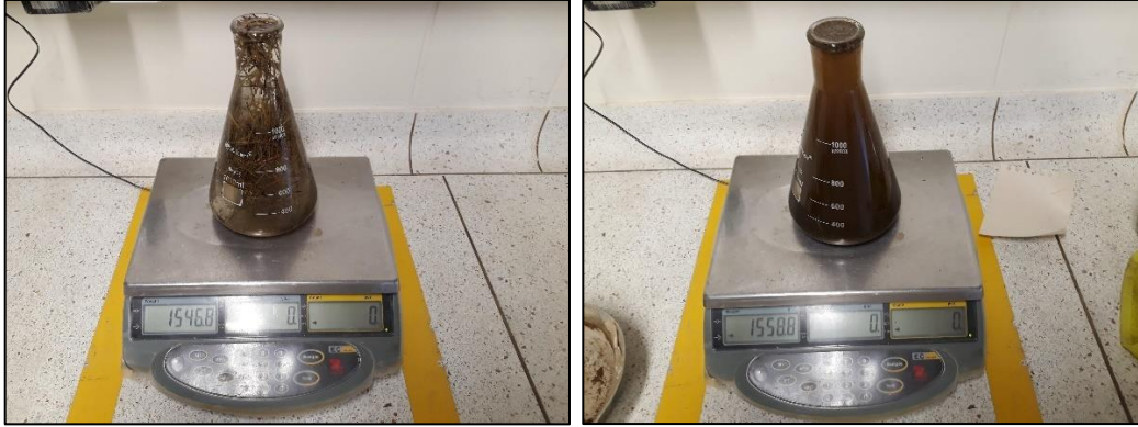
Ilustración 55. Pesaje de la fibra en matraz con agua. (tipo A - tipo B)
