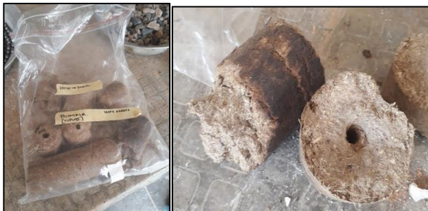
Ilustración 48. Bagazo tipo B. (Procesada y compactada)
