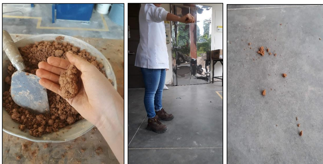
Ilustración 57. Ensayo de contenido de humedad en campo.
