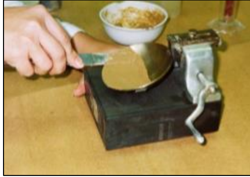
Ilustración 12. Colocación del suelo dentro de la cazuela.
