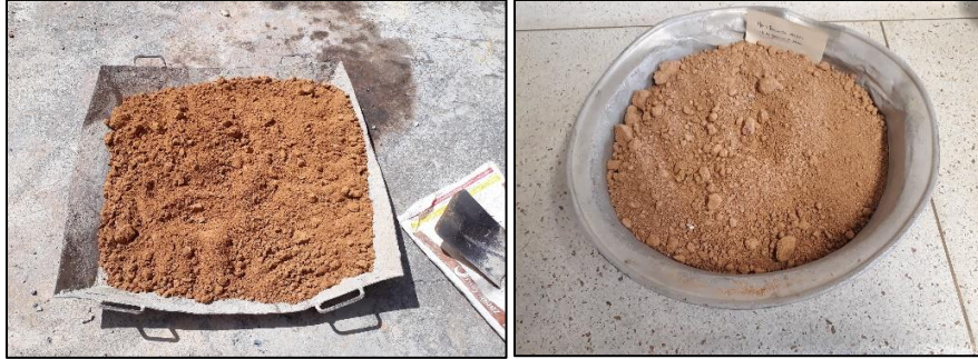
Ilustración 43. Muestra secada al aire libre y en el horno.
