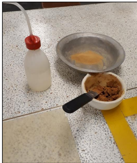
Ilustración 38. Preparación de material para ensayo de límite plástico.
