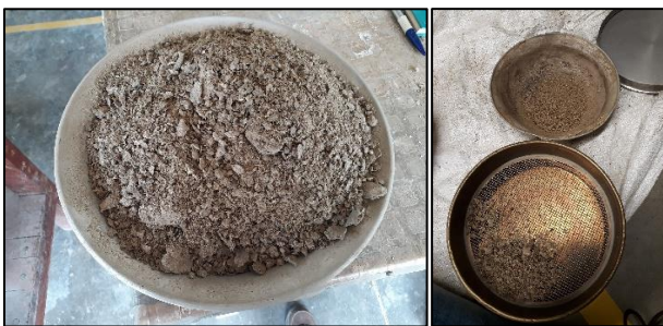
Ilustración 50. Cernida del material triturado.
