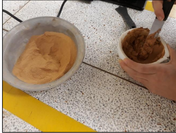
Ilustración 35. Mezcla de la muestra previamente preparada y agua, buscando contenidos adecuados.
