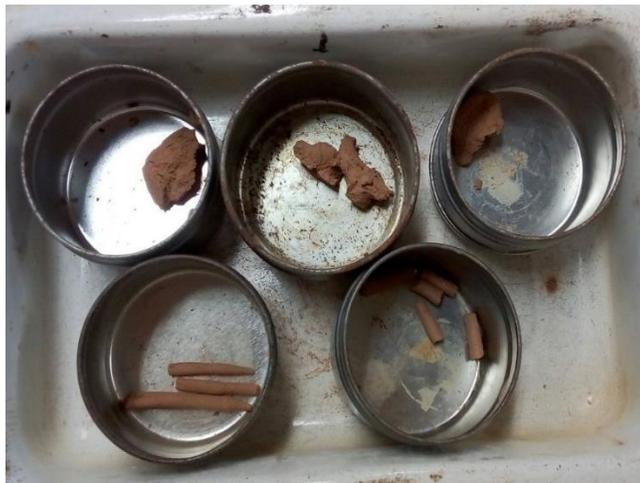
*Figura 10. Capsulas con suelo para determinación de humedad.*
