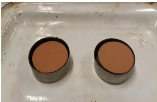
*Figura 12. Muestras de contracción secadas en el horno.*
