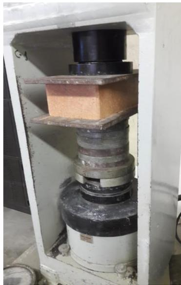
*Figura 20. Ensayo de compresión simple.*
