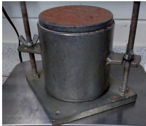
*Figura 15. Molde con muestra compactada.*
