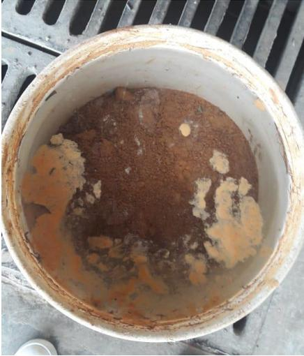
*Figura 33. Bloque de suelo inalterado sumergido por 24 horas*
