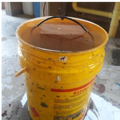
*Figura 32. Bloque de suelo cemento sumergido por 24 horas*
