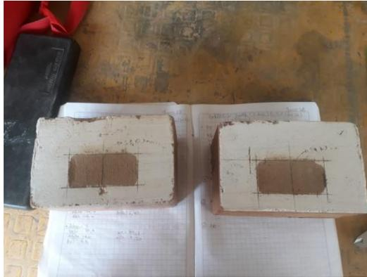
*Figura 23. Medición de huella de abrasión.*
