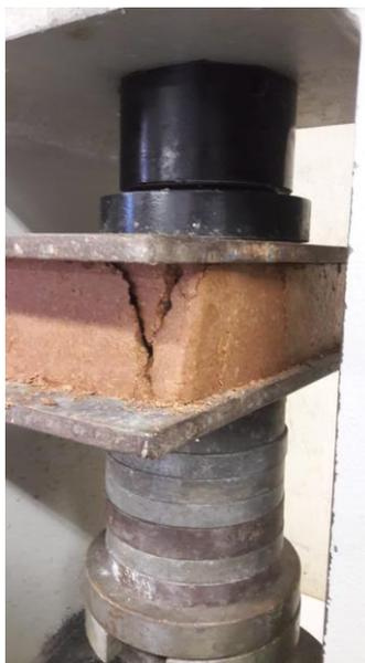
*Figura 21. Falla de la muestra luego de aplicar la carga.*
