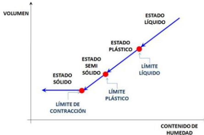
Figura 3. Consistencia del suelo en base a su humedad y volumen.
