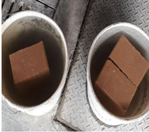
*Figura 24. Bloques de 7% cemento sumergidos.*
