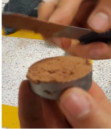
*Figura 11. Preparación de muestra para contracción*
